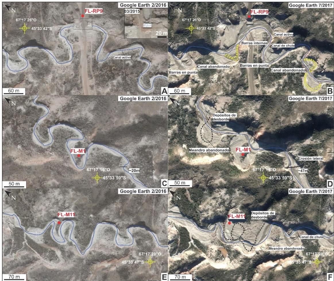
Figura 28. Cauce principal de la cuenca Bajo Palangana cerca de su desembocadura, comparación de imágenes Google Earth™ previas (02/2016) y posteriores al temporal (07/2017). A) Intersección con RPN°1, obra pluvial de hormigón construida en marzo de 2015 y cauce de alta sinuosidad. B) Camino erosionado (~45 m) y exposición de la obra civil, canales abandonados, patrón multicalizado y depósitos de desborde sobre planicie de inundación proximal. C) Canal meandroso previo al temporal en punto FL-M1. D) Meandros estrangulados, disminución de la sinuosidad y ensanchamiento del cauce en FL-M1. E) Cauce previo al temporal en punto FL-M11. F) Rectificación del canal y abundante sedimentación de depósitos de desbordamiento en FL-M11.
