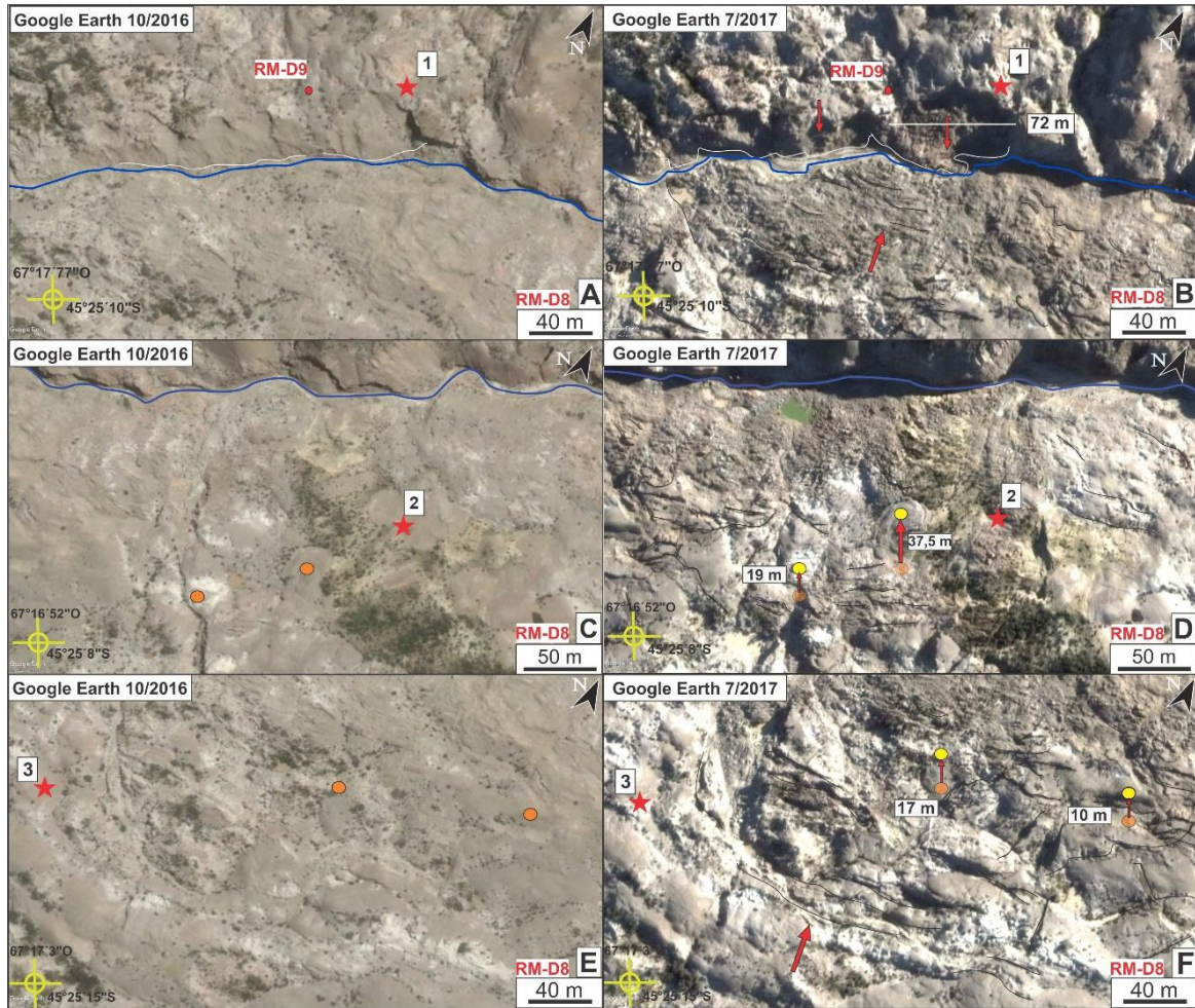
Figura 51. Modificaciones geomorfológicas asociadas a deslizamientos (RM-D8 y RM-D9) sobre cauce del Cañadón Pilar, imágenes Google Earth™. A) Imagen previa al temporal (12/10/2016). B) Imagen posterior al temporal (27/07/2017), con la formación del deslizamiento RM-D9. C) Imagen previa al temporal (12/10/2016) sobre la margen sur del valle. Los puntos anaranjados corresponden a la ubicación inicial de puntos de control. D) Imagen posterior al temporal (27/07/2017), se indica el desplazamiento de los puntos de control. E) Imagen previa al temporal (12/10/2016), margen sur del valle. F) Imagen posterior al temporal (27/07/2017). Observar la apertura de grietas superficiales y desplazamiento de puntos de control.
