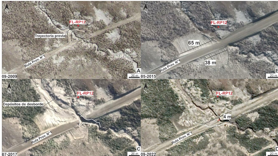
Figura 26. Punto FL-RP12 sobre la RPN°1. A) Imagen Google Earth™ previa a obras civiles de la Ruta Provincial N°1 (25/09/2009). B) Imagen Google Earth™ de la ruta terminada antes del temporal (04/05/2015). C) Imagen Google Earth™ luego del temporal de 2017 (27/06/2017). D) Imagen Google Earth™ luego de las precipitaciones del 19-20/09/2022. Observar las similitudes de la figura A y D.
