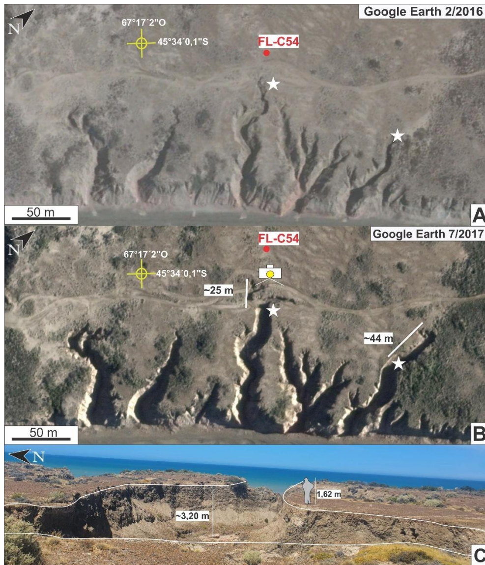
Figura 25. Erosión retrocedente de cárcavas sobre acantilados, punto FL-C54. A) Imagen previa al temporal de 2017. B) Imagen posterior al temporal, las estrellas blancas indican puntos de referencia para la visualización de cambios. C) Fotografía sobre borde de cárcava de una profundidad de hasta ~3,2 metros y ancho de ~5 metros.
