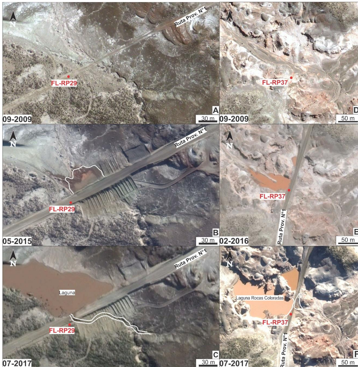
Figura 27. Imágenes Google Earth™ sobre la RPN°1 en el ANPRC. A) Localidad FL-RP29 antes de la construcción de ruta (09/2009), dónde el curso efímero escurría sin mayores dificultades. B) Construcción de la ruta con un terraplén cortando el cauce principal (05/2015). C) Endicamiento y erosión de la ruta por el temporal de 2017 (07/2017). D) Localidad FL-RP37 antes de obra civil (09/2009). E) Construcción de la RPN°1, con incipiente acumulación de agua sobre el margen oeste (02/2016). F) Formación de lagunas y erosión de la ruta después de la tormenta (07/2017).
