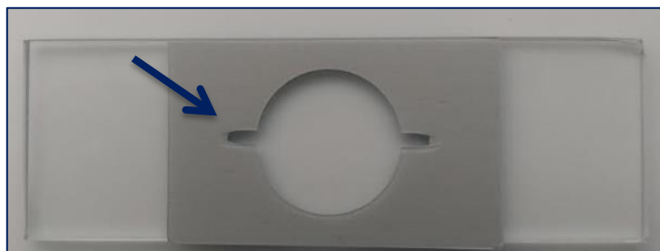
Figura N°12: Cámara Palmer Maloney y zona de carga.
