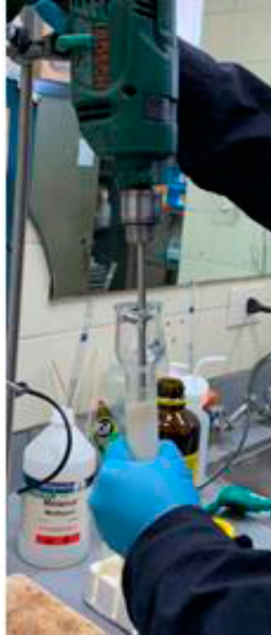
Fig. 8. Obtención del homogeneizado de carne cruda de almeja
