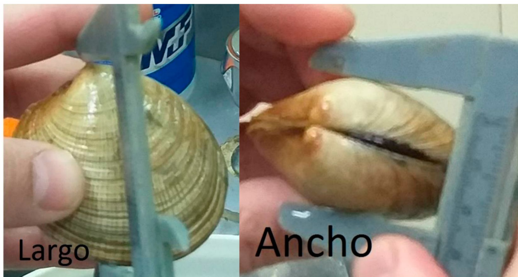
Figura 10: Medición del largo y ancho de las almejas mediante un calibre.
