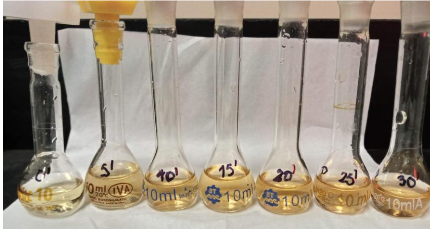
Figura 3.5 Imagen de las soluciones actinométricas luego del tiempo de irradiación (min). De izquierda a derecha se observa desde el blanco sin irradiar, hasta la solución luego de 30 min de irradiación.
