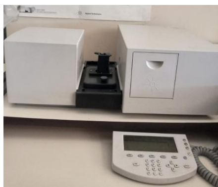
Figura 3.3. Imagen de espectrofotómetro agilent 8453E UV-visible.
