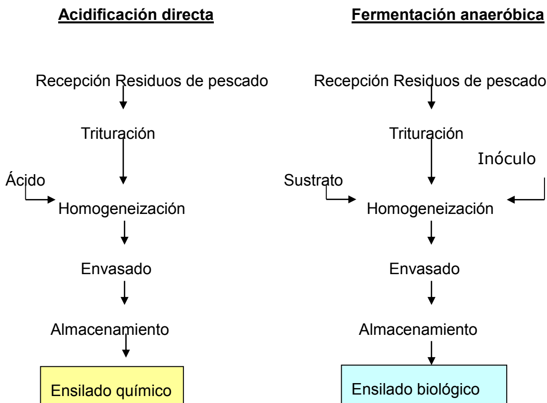
Fig. 8: Esquemas de secuencia de proceso de acidificación química y fermentación anaeróbica.
