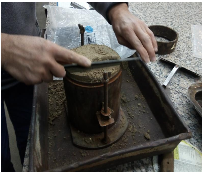
Figura 51: Entallado de la cara superior de la probeta de suelo (Izq.) y el resultado final (der.)
