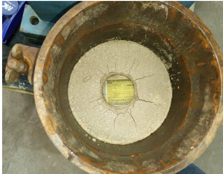
Figura 56: Superficie penetrada de la probeta de suelo, una vez retiradas las sobrecargas y su base
