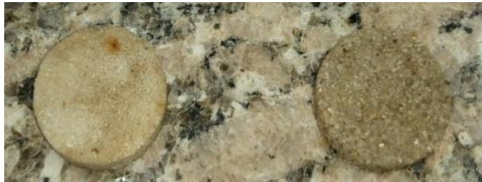
Figura 13: Comparación entre la piedra porosa original (izq.) y la artificial (der.)
