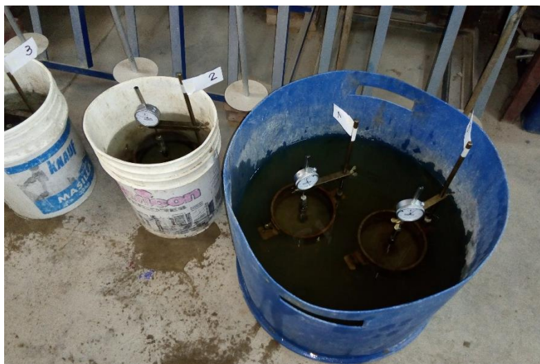
Figura 53: Moldes sumergidas en sus respectivos recipientes
