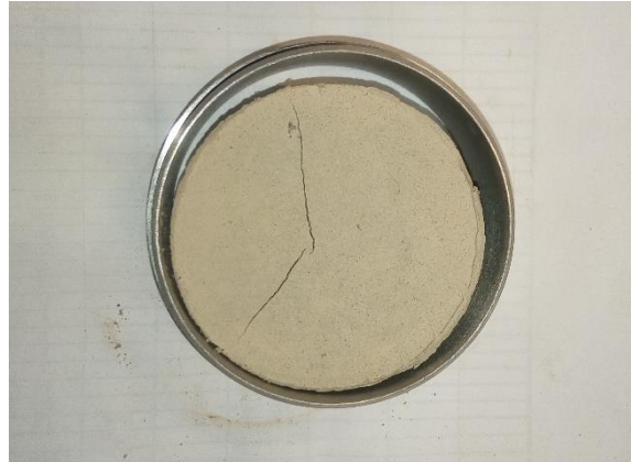
Figura 68: Muestra de suelo secada en horno, presentando fisuras en su superficie
