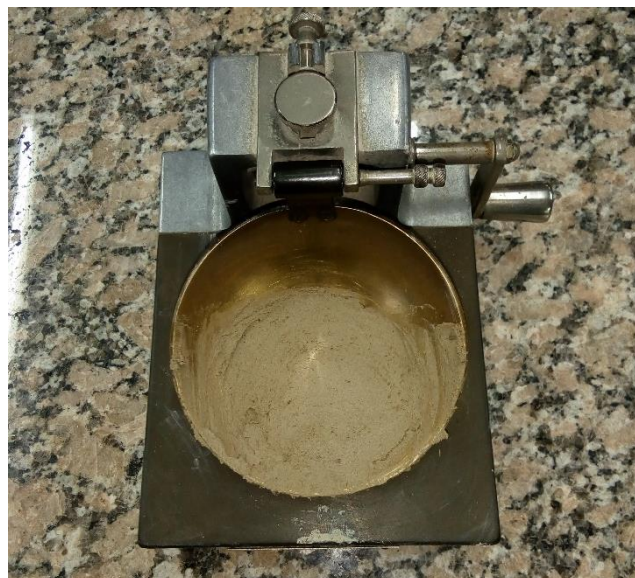
Figura 39: Muestra de suelo enrasada en el cascador de Casagrande
