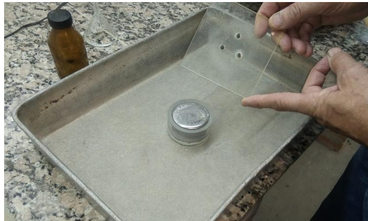
Figura 48: Enrase del recipiente volumétrico con mercurio
