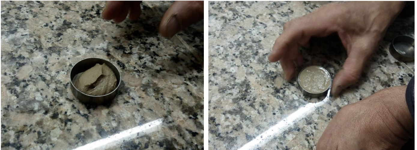
Figura 46: Colocación de suelo en la capsula (Izq.) y golpeo para evitar oquedades (der.)
