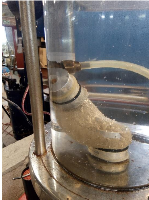
Figura 2: Probeta de suelo ya deformada e inutilizada para el análisis de humedad
