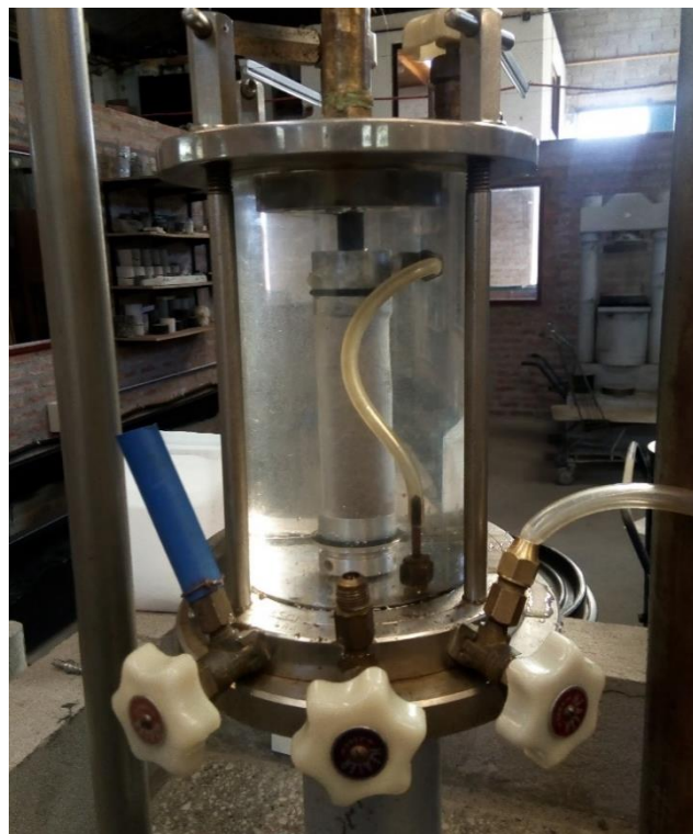
Figura 14: Ensayo inicial de una probeta de suelo, con la cámara triaxial cargada con
