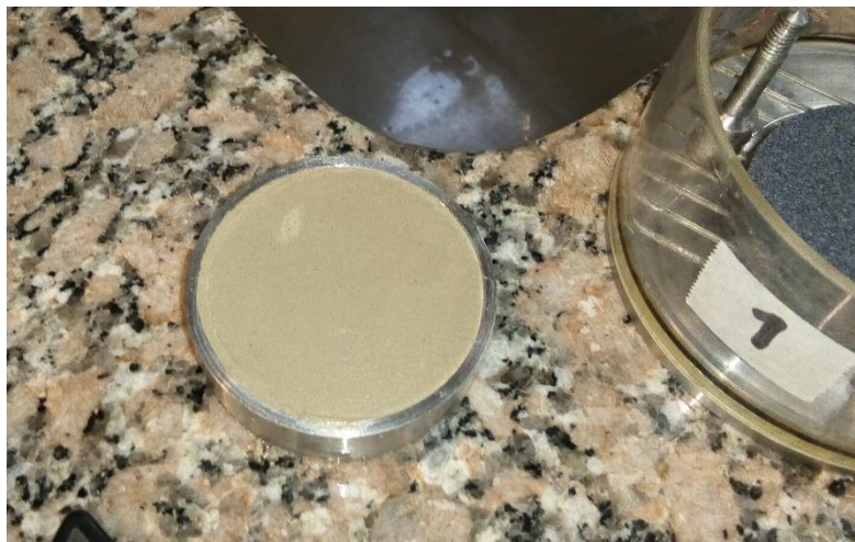
Figura 61: Conjunto de Anillo metálico + Suelo húmedo moldeado
