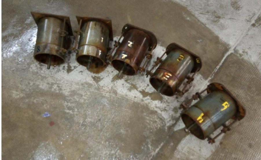
Figura 54: Moldes ya retirados y volcados para su drenaje
