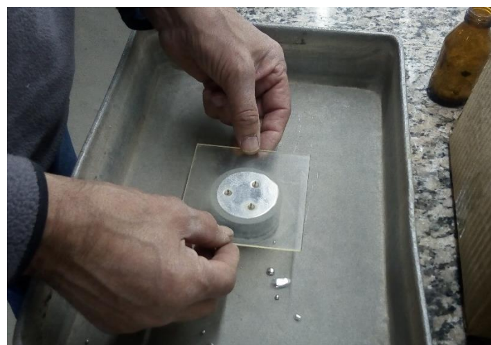
Figura 49: Inmersión de la "galleta" de suelo en mercurio y enrasado
