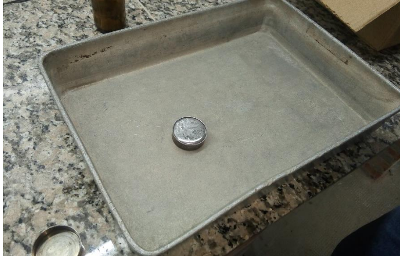
Figura 43: Capsula metálica + Mercurio enrasado
