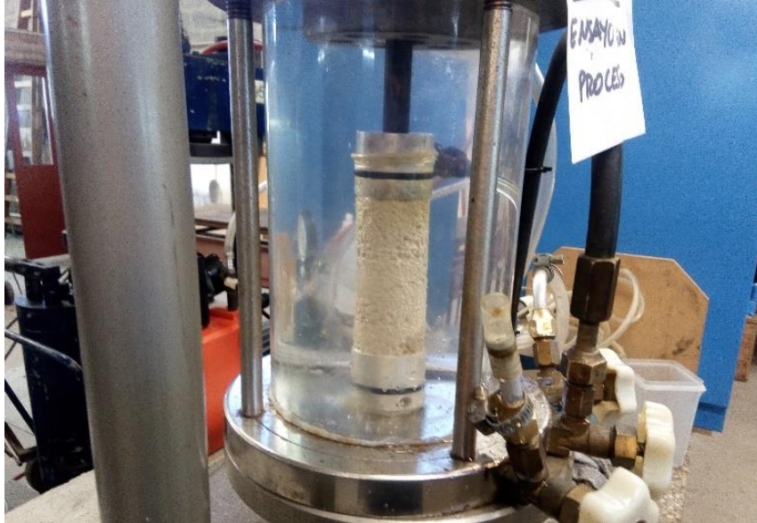
Figura 7: Probeta de suelo ensayada dentro de la cámara triaxial
