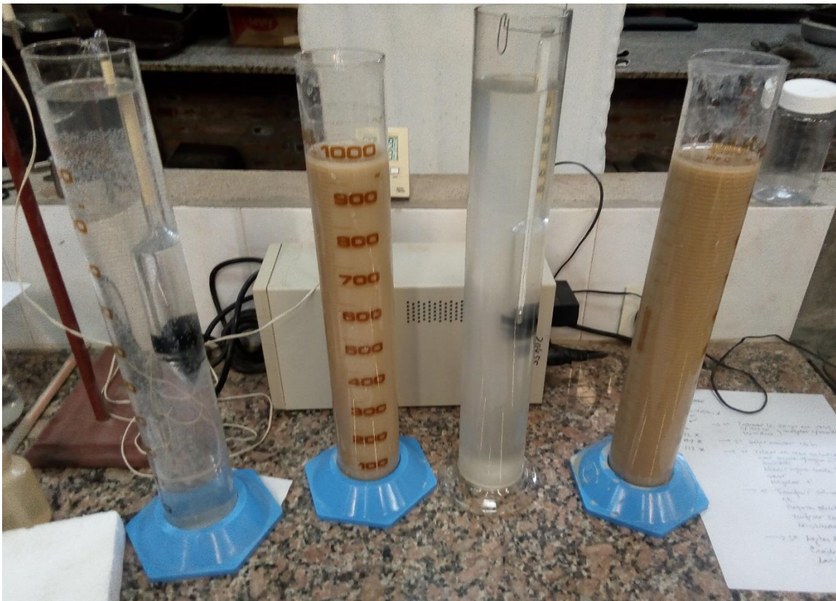
Figura 14: Probetas de control y con la suspensión de suelo para H-151 (izq.) y Probetas de control y con la suspensión de suelo para H-152 (der.)
