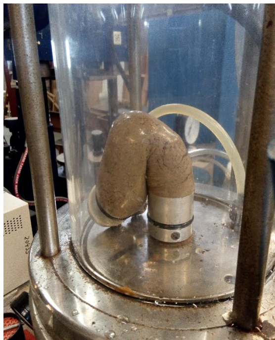
Figura 8: Probeta de suelo ya deformada e inutilizada para el análisis de humedad
