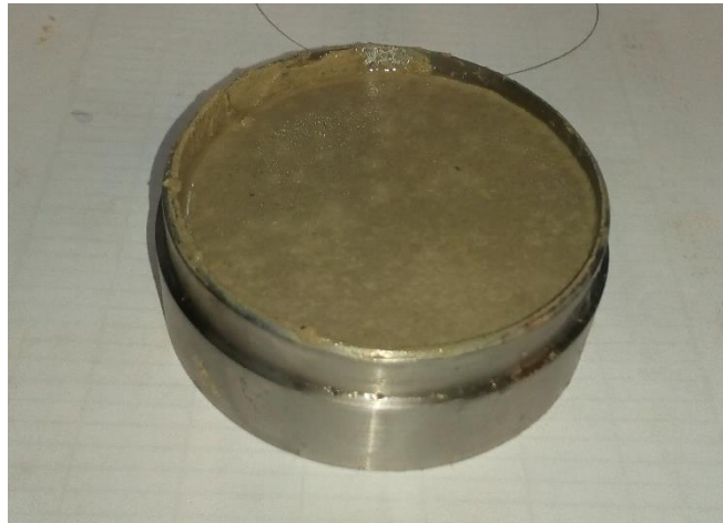
Figura 66: Conjunto Anillo+Suelo retirada del consolidómetro, una vez finalizado el ensayo
