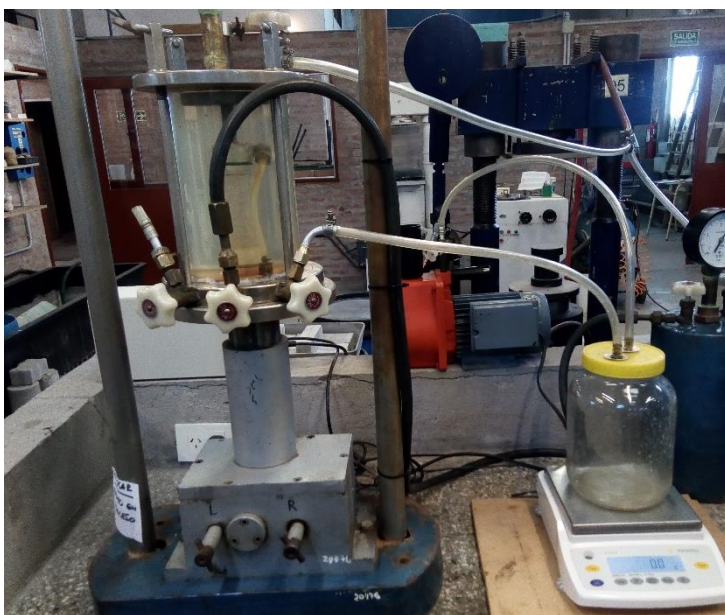
Figura 4: Equipo de ensayo trabajando con la bomba e succión (izq.) o trabajando a presión atmosférica (der.)
