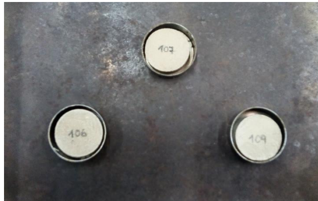
Figura 47: "Galletas de suelo" luego del secado en horno
