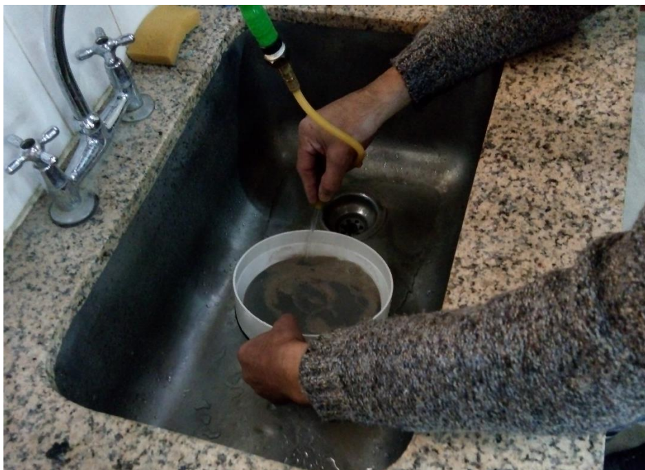
Figura 15: Tamizado por vía húmeda de la muestra de suelo
