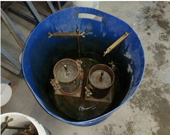
Figura 52: Moldes ubicados ya en el recipiente, junto con la varilla de extensión y el prisionero (izq.) y el flexímetro colocado, ya puesto en 0 (der.)
