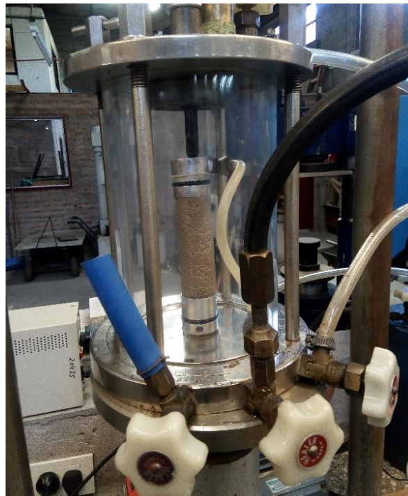
Figura 24: Probeta ensayada dentro de la cámara triaxial, cargada con aire presurizado
