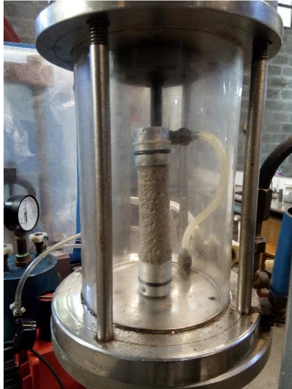
Figura 20: Probeta de suelo ensayada con cámara triaxial cargada únicamente con aire
