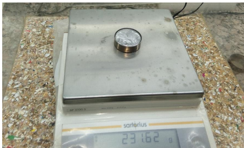
Figura 44: Pesada de conjunto Cápsula + Mercurio
