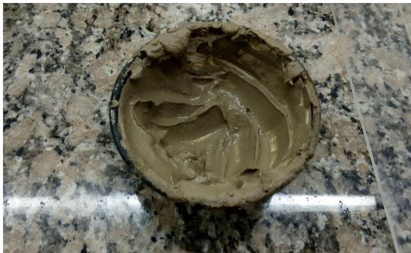
Figura 42: Consistencia de suelo para Ensayo de contracción
