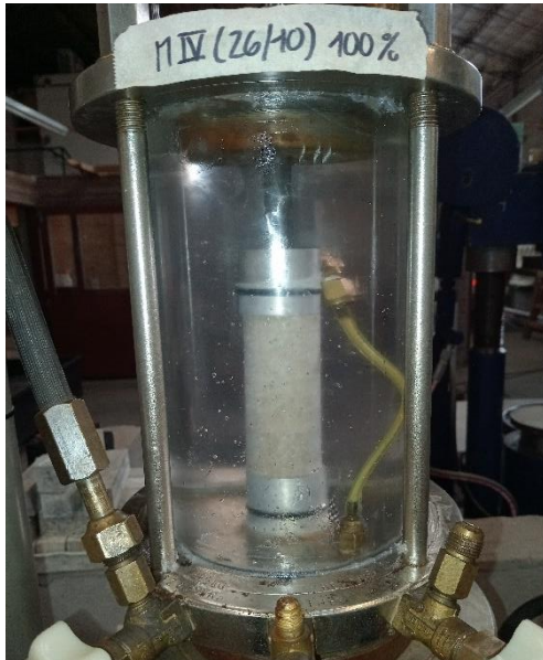
Figura 37: Probeta de suelo antes (izq.) y después (der.) del ensayo
