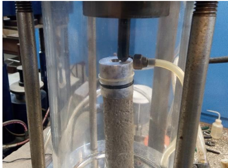
Figura 26: Vástago descentrado del cabezal superior, luego de finalizado el ensayo
