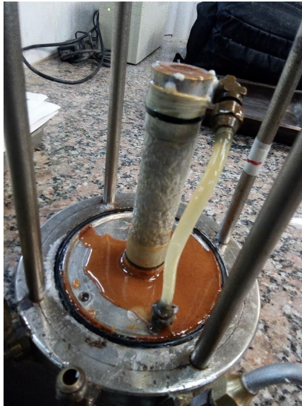
Figura 6: Probeta de suelo luego de concluido el ensayo, sujeta todavía a la base de la cámara triaxial
