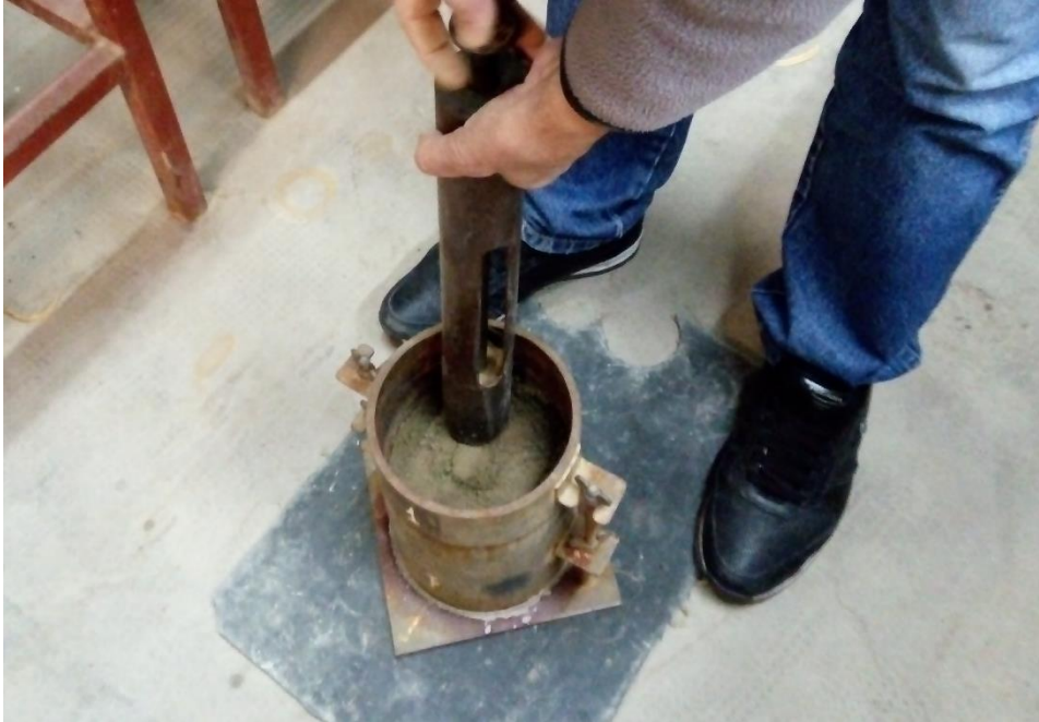
Figura 50: Compactación del suelo dentro del molde
