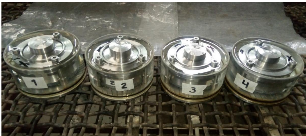
Figura 63: Consolidómetros inundados con agua, listos ya para ensayar
