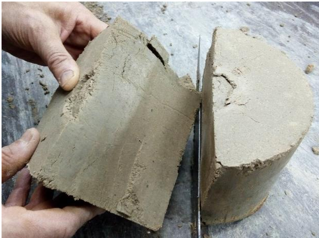
Figura 60: Probeta de suelo dividida transversalmente (izq.) y contraste del grosor de las fisuras en el suelo con un lápiz (der.)
