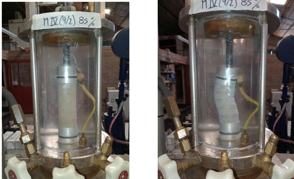
Figura 32: Probeta de suelo antes (izq.) y después (der.) del ensayo
