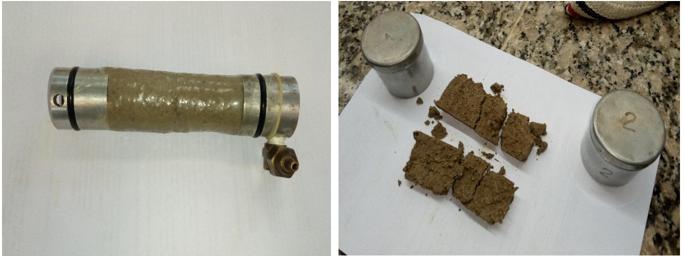
Figura 25: Probeta retirada una vez finalizado el ensayo (izq.) y toma de muestras para el análisis de humedad (der.)
