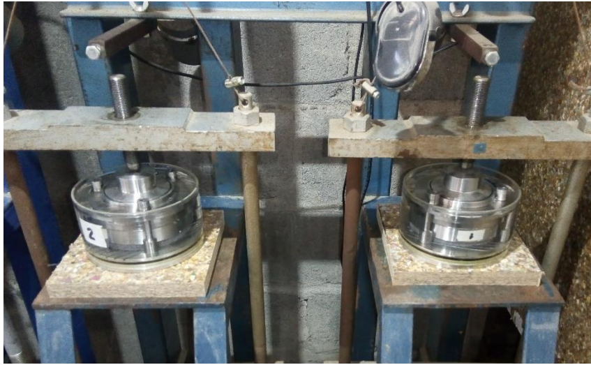
Figura 64: Consolidómetros colocados en el dispositivo de carga, con el vástago ya en posición
