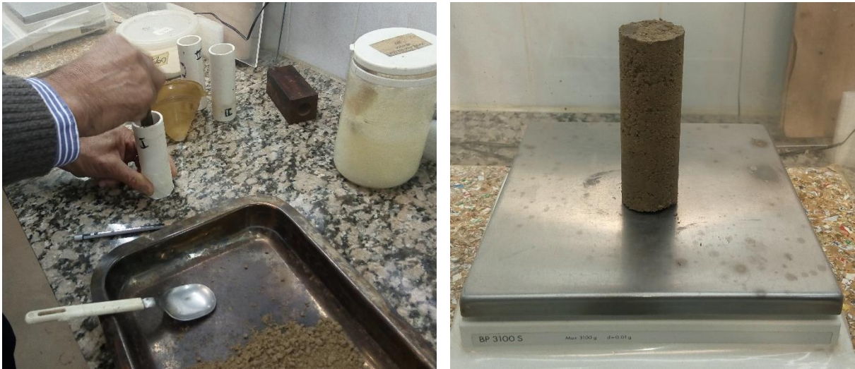
Figura 16: Compactación por capas del suelo dentro del tubo de moldeo (izq.) y pesaje de la probeta de suelo obtenida (der.)
