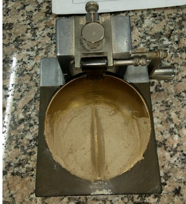
Figura 40: Muestra de suelo acanalada sobre el cascador, lista para golpear
