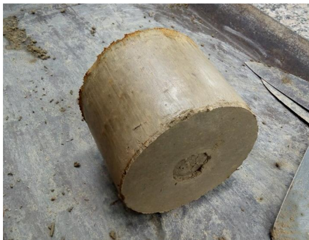
Figura 59: Probeta de suelo liberada del molde
