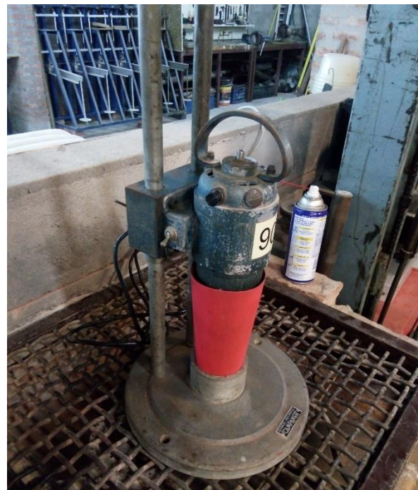
Figura 13: Vaso del mezclador cargado (izq.) y mezcladora en funcionamiento (der.)
