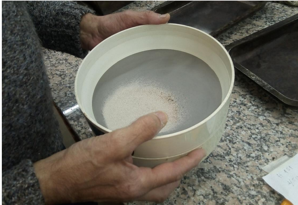
Figura 16: Tamizado en seco de la muestra de suelo
