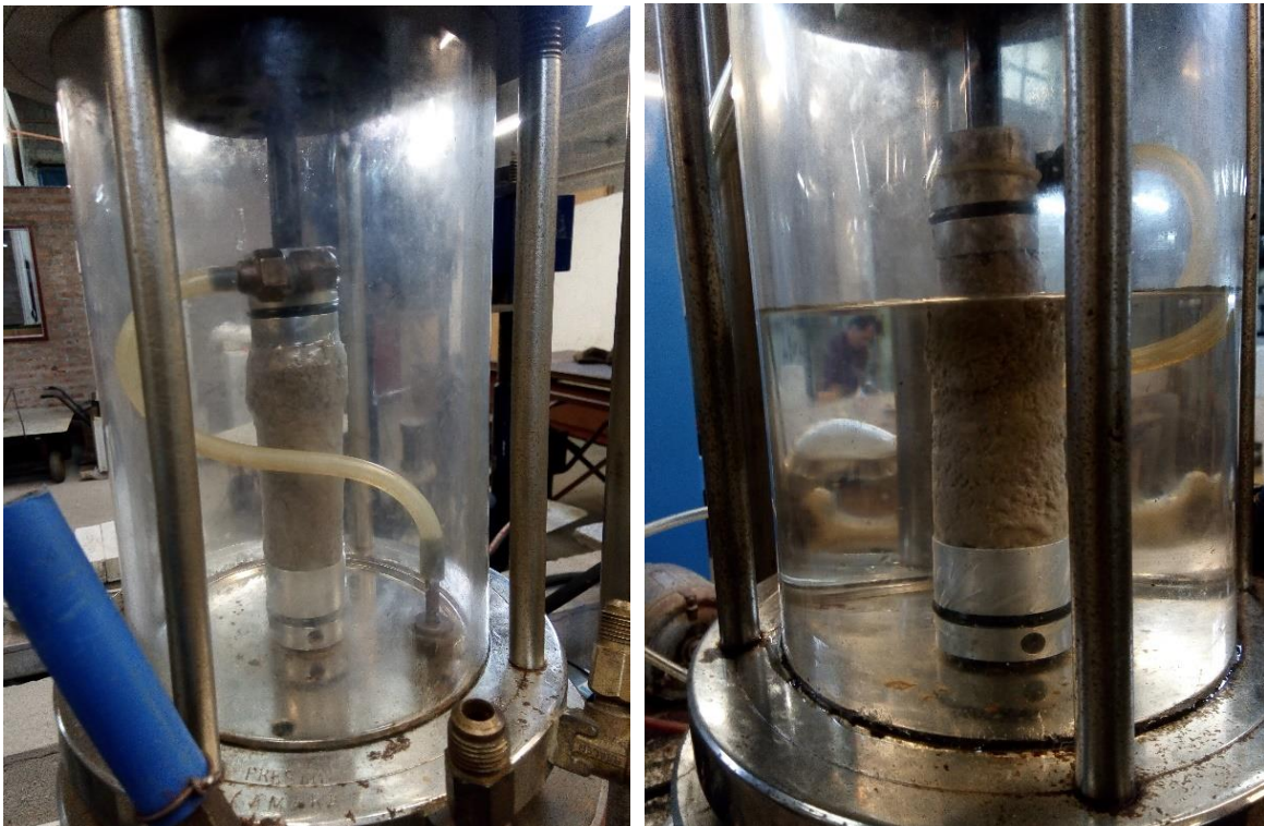
Figura 19: Probeta presentando una falla por compresión en su zona superior (izq.) y cámara triaxial descargándose durante el ensayo (der.)
