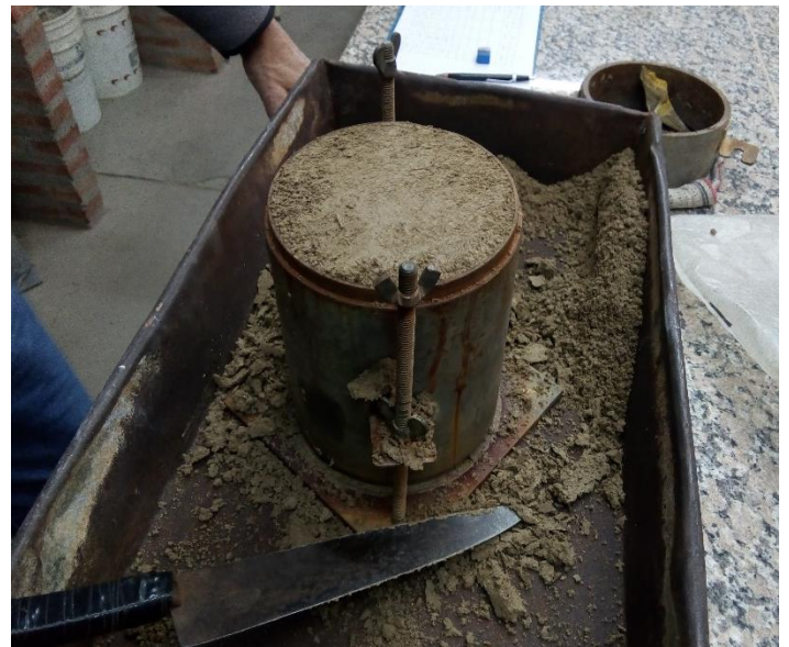
Figura 51: Entallado de la cara superior de la probeta de suelo (Izq.) y el resultado final (der.)
