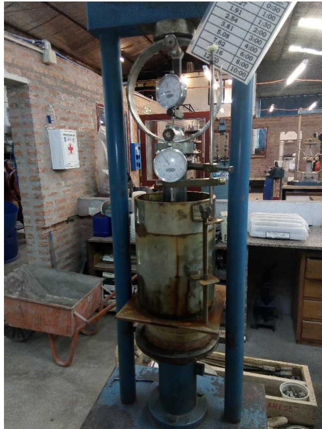
Figura 55: Molde de suelo posicionado en el marco de carga, con los flexímetros ya posicionados y listo para ensayar
