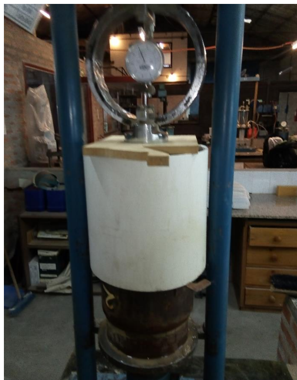
Figura 57: Molde con el tubo de PVC y el suplemento de madera posicionados para la extracción de la probeta de suelo
