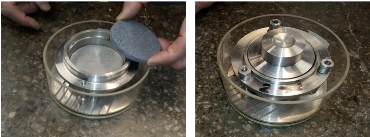
Figura 62: Colocación del geotextil y la piedra porosa sobre el conjunto Anillo+Suelo (izq.) y la pesa metálica (der.)
