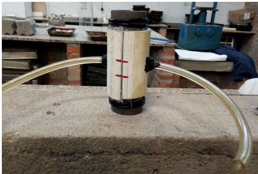
Figura 17: Prototipo del sistema de colocación de membrana por succión
