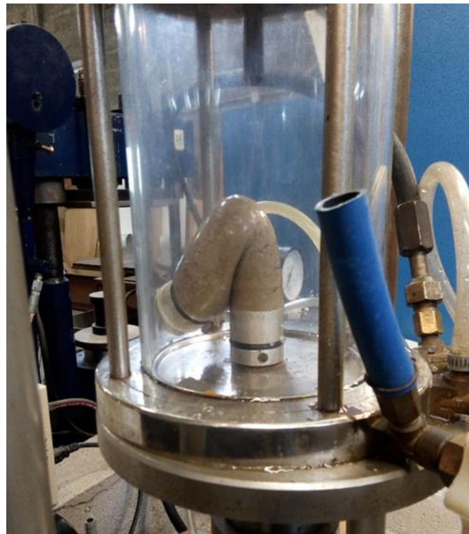
Figura 22: Probeta de suelo ya deformada e inutilizada para el análisis de humedad
