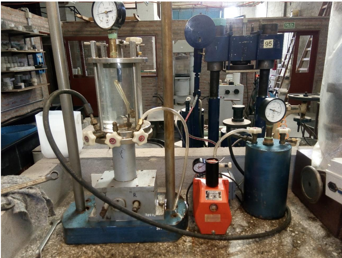
Figura 9: Disposición inicial del equipo. De izquierda a derecha, la cámara triaxial (sobre el marco de carga), la bomba y el pulmón hidroneumático.
