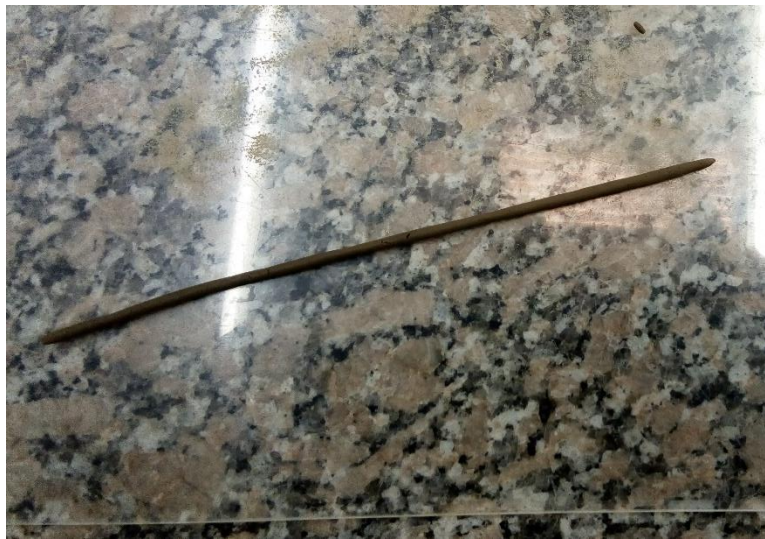
Figura 41: Cilindro amasado de suelo húmedo, ya presentando unas pocas fisuras o grietas
