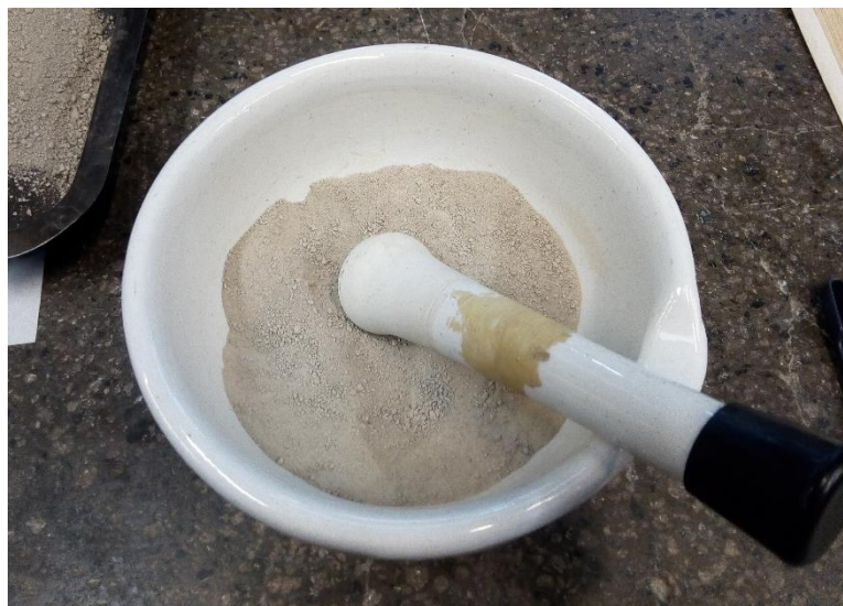
Figura 11: Muestra de suelo seco y pulverizado
