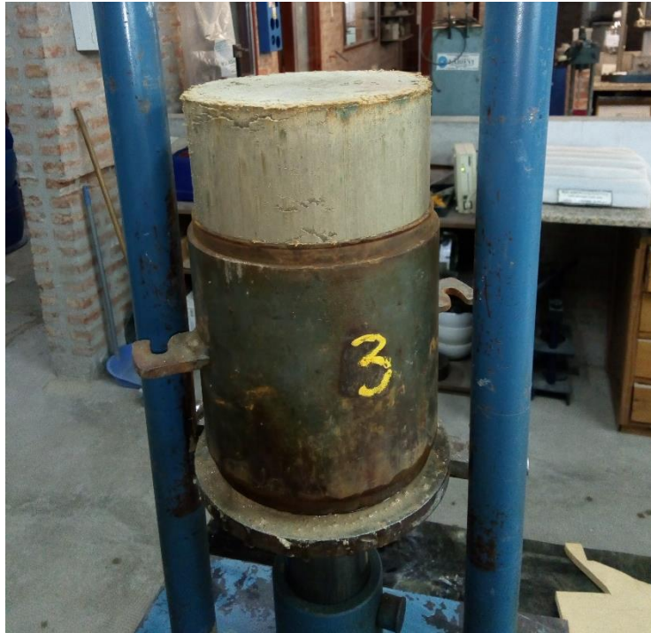
Figura 58: Probeta de suelo separándose de las paredes del molde
