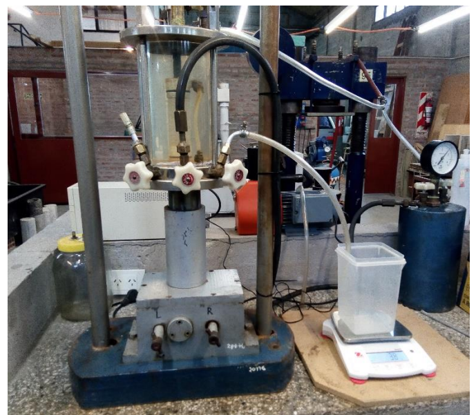
Figura 4: Equipo de ensayo trabajando con la bomba e succión (izq.) o trabajando a presión atmosférica (der.)
