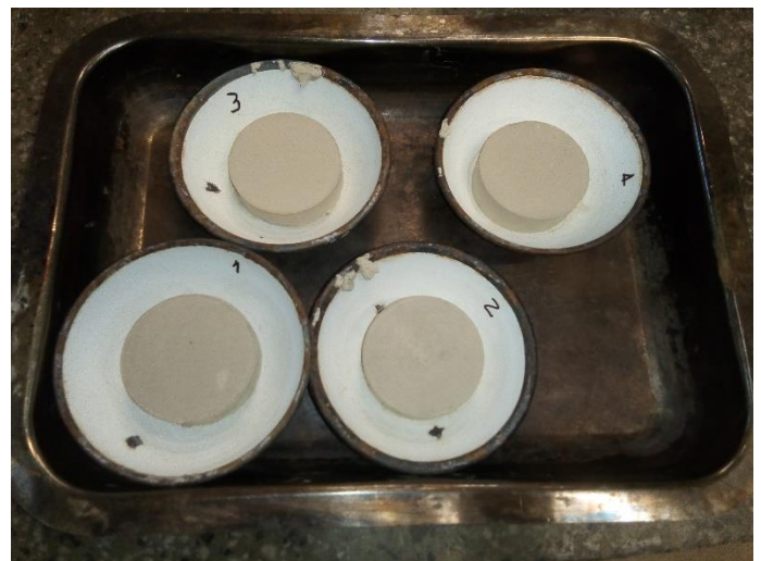
Figura 67: Muestra de suelo retirada del anillo metálica (izq.) y las 4 muestras ya retiradas y listas para su secado (der.)
