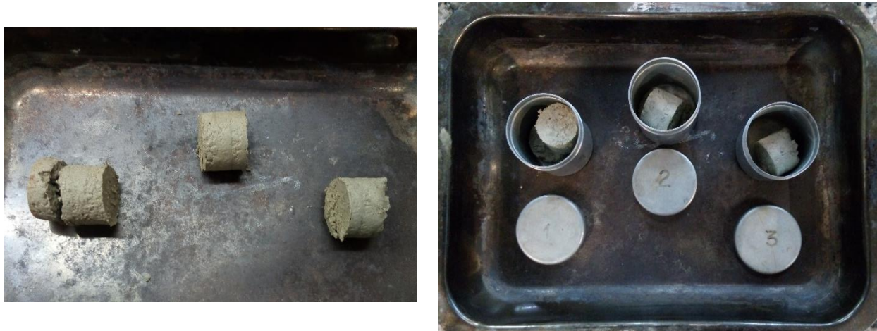
Figura 10: Toma de muestras para análisis de humedad. De izq. a der.: Sección Inferior, Central y Superior.
