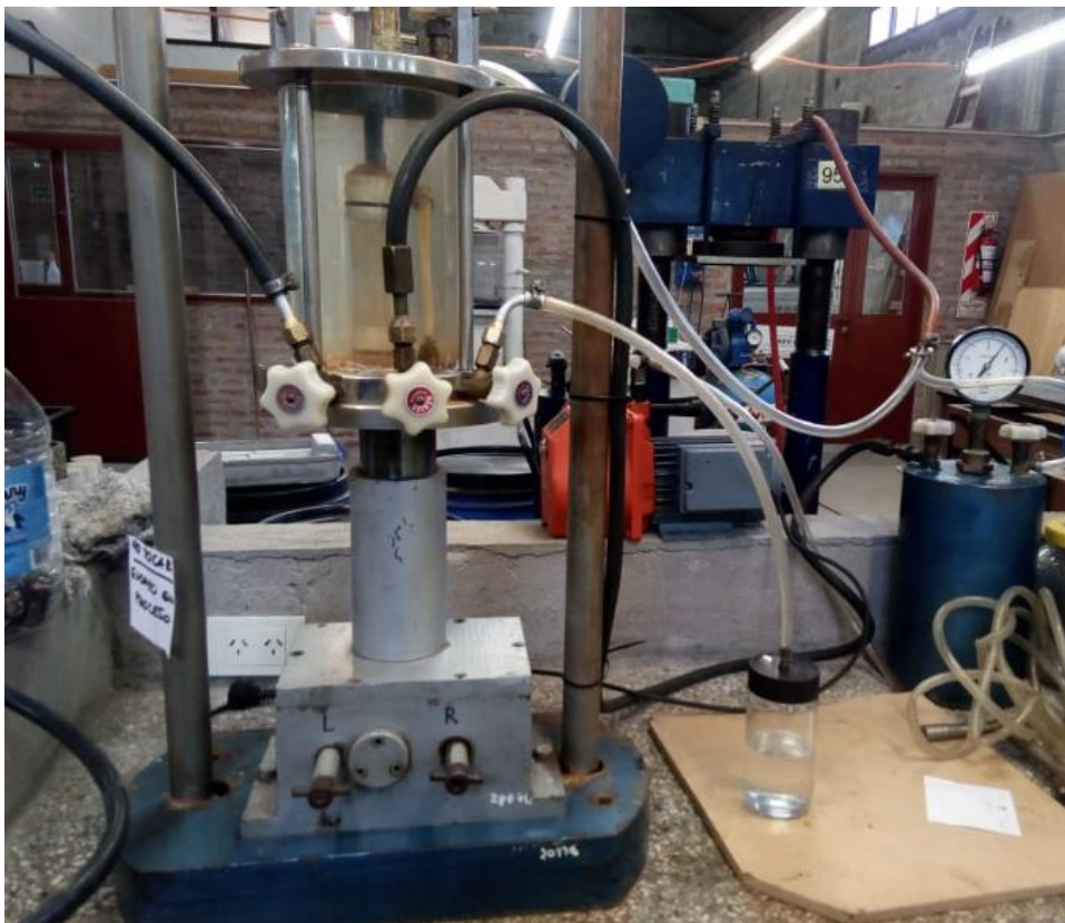
Figura 9: Equipo de cámara triaxial, con la probeta de suelo ya instalada y el nuevo recipiente recolector
