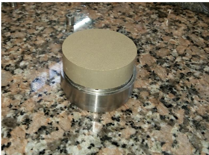
Figura 67: Muestra de suelo retirada del anillo metálica (izq.) y las 4 muestras ya retiradas y listas para su secado (der.)
