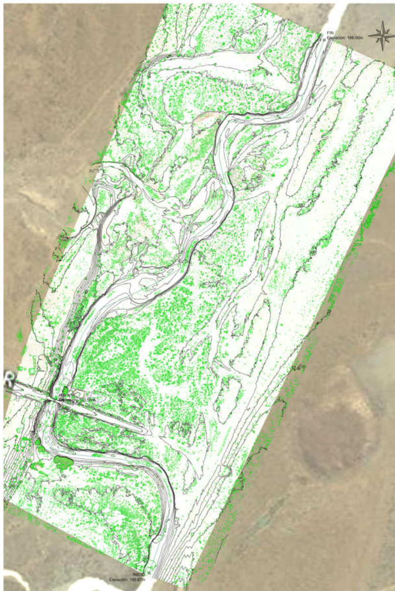
Imagen 18. Se observan las curvas descartadas en color. Las demás se emplean para generar la superficie.
