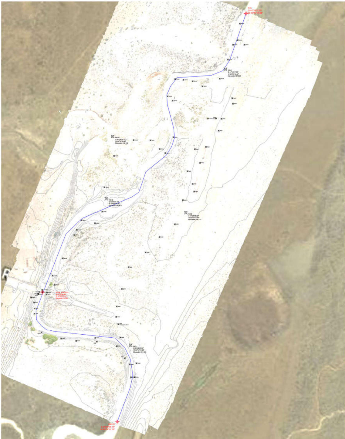
Imagen 19. Planimetría con la traza generada (azul), puntos de referencia (rojo), y puntos tomados por el GPS
