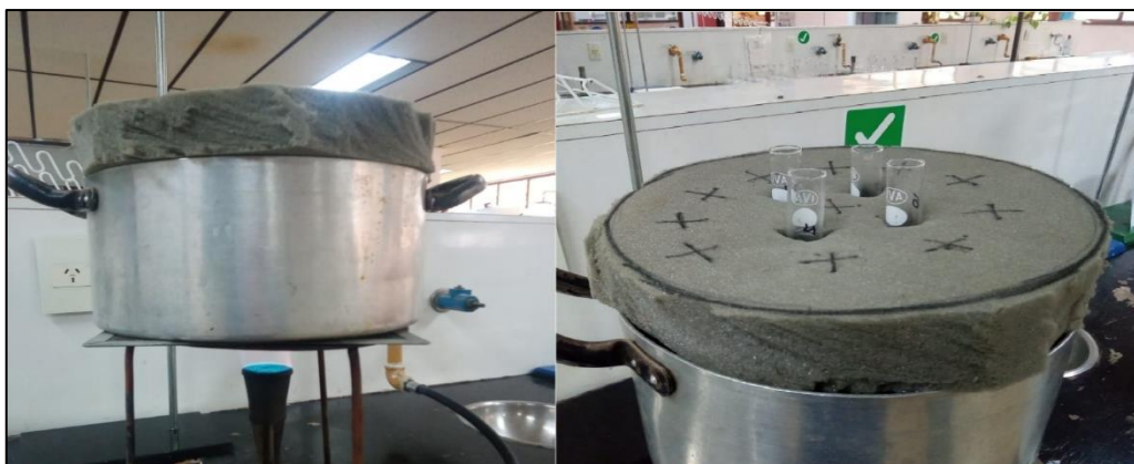
Figura 9. Determinación de Nitratos. Muestras llevadas a un baño maría de agua hirviendo
