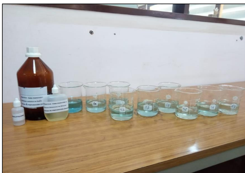
Figura 7. Determinación de Fosfatos. Muestras preparadas para la determinación de fosfatos a través de la metodología de espectrofotometría.
