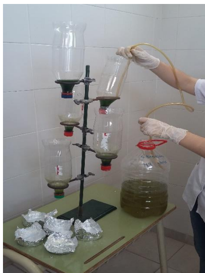
Fig. 12. Sifonado de la 2da decantación.
