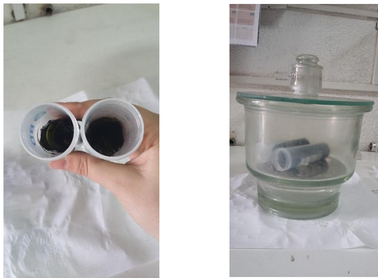
Fig. 15. Izquierda: biomasa seca post estufa; Derecha: biomasa en desecador previa a ser pesada.
