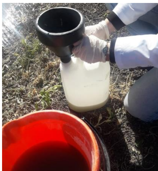
Fig. 5. Toma de muestra de efluente de matadero con filtrado grueso.
