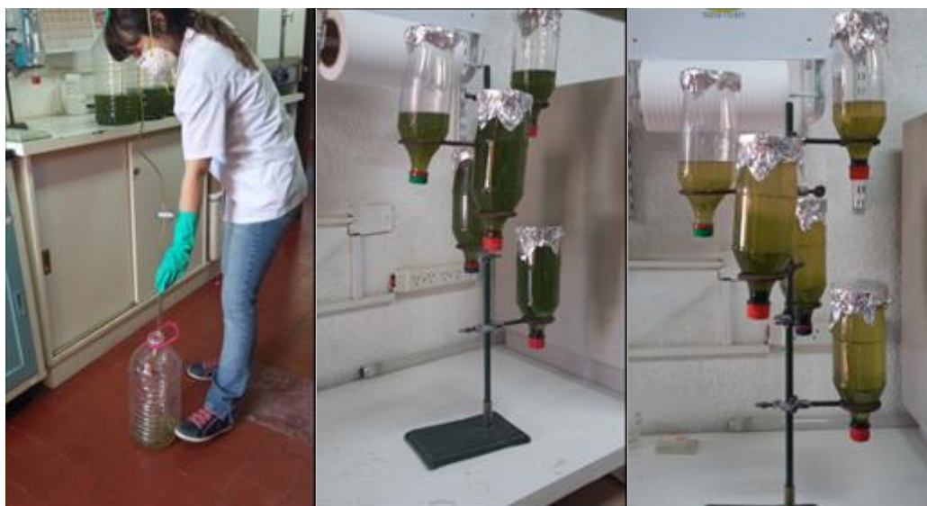
Fig.11. Izquierda: sifonado y 1ra decantación; Centro y derecha: 2da decantación.
