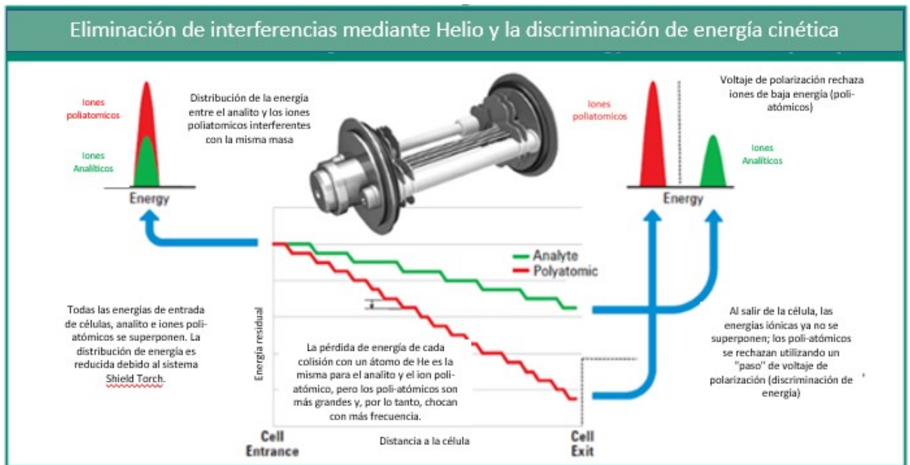
Figura N° 19: Espectrometría de masas por plasma acoplado inductivamente, esquema: como el modo de celda de colisión con helio elimina la interferencia espectral.
