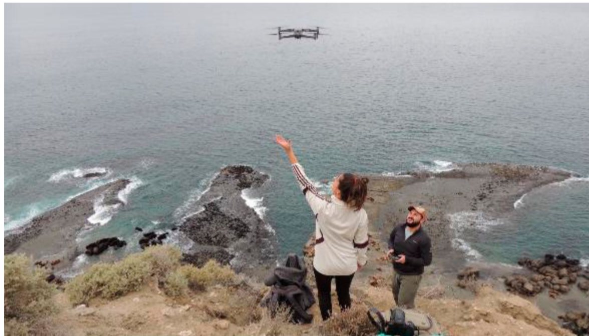
Figura 5. Aterrizaje posicionando el VANT al alcance del auxiliar, manejado por el piloto.
