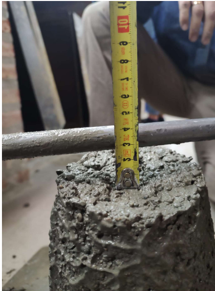
Figura 31 Ensayo de asentamiento relación a/c 0,35
