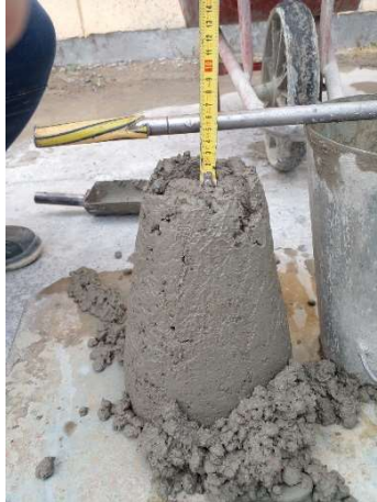
Figura 22 Ensayo de Asentamiento a/c 0,55 (árido corregido)
