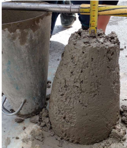
Figura 21 Ensayo de Asentamiento a/c 0,55 (árido corregido)
