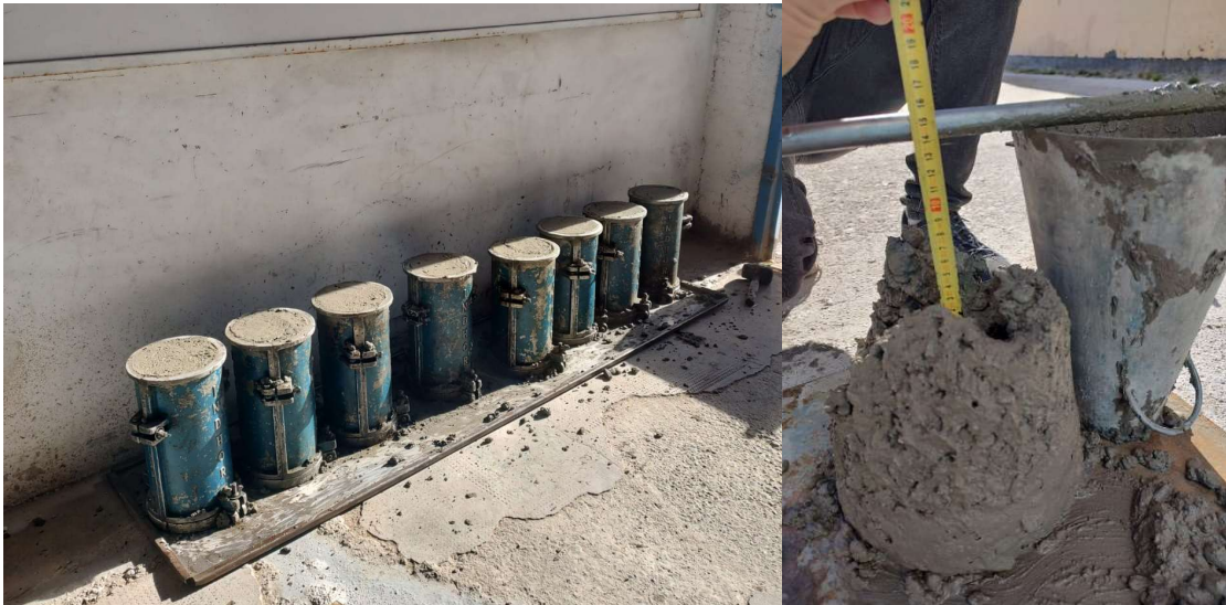
Figura 23 Ensayo de asentamiento y moldeo relación a/c 0,55
