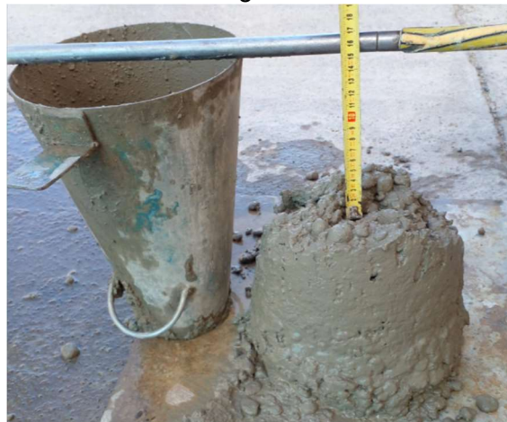
Figura 18 Ensayo de Asentamiento a/c 0,55 (árido corregido)
