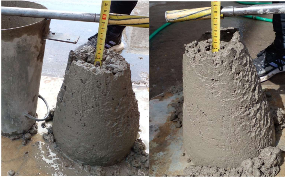
Figura 20 Ensayo de Asentamiento a/c 0,55 (árido corregido)
