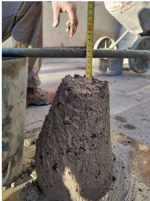
Figura 33 Ensayo de asentamiento relación a/c 0,55 (Repetición)
