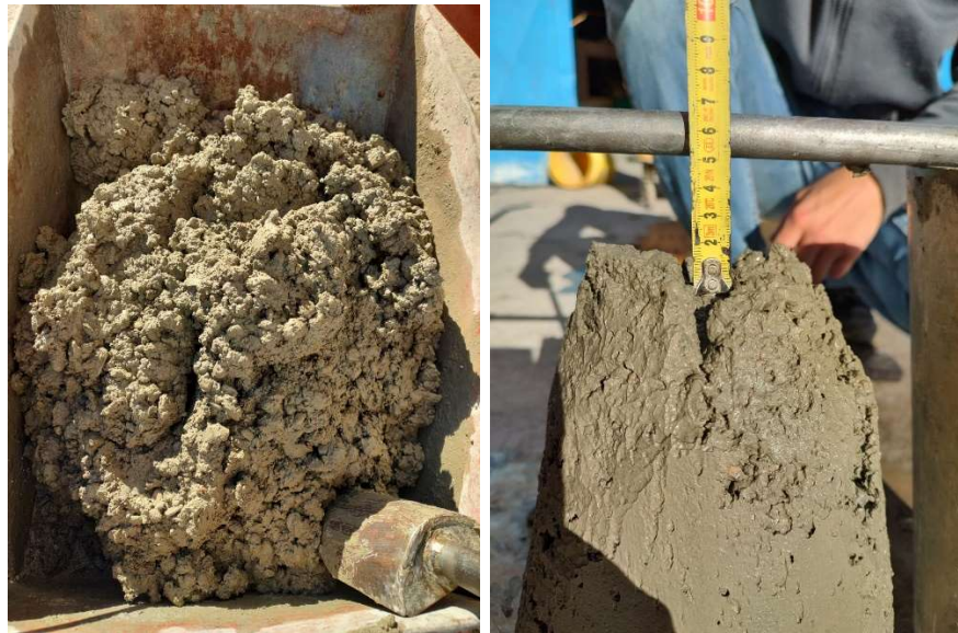
Figura 25 Ensayo de asentamiento relación a/c 0,40
