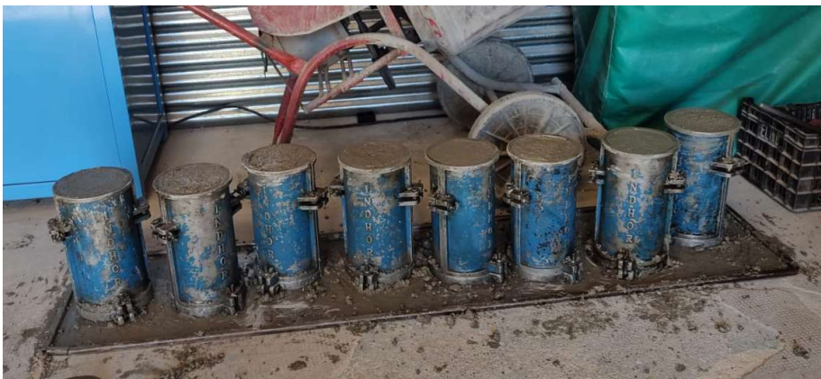
Figura 24 Ensayo de asentamiento y moldeo relación a/c 0,45
