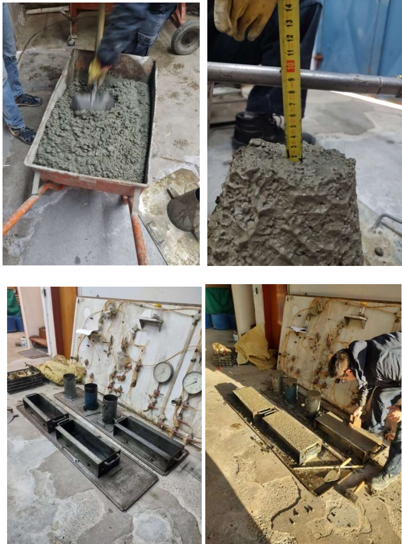
Figura 26 Ensayo de asentamiento y moldeo relación a/c 0,50
