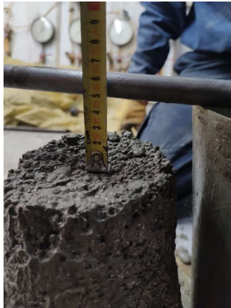
Figura 27 Ensayo de asentamiento relación a/c 0,55
