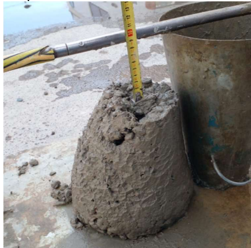
Figura 19 Ensayo de Asentamiento a/c 0,55 (árido corregido)
