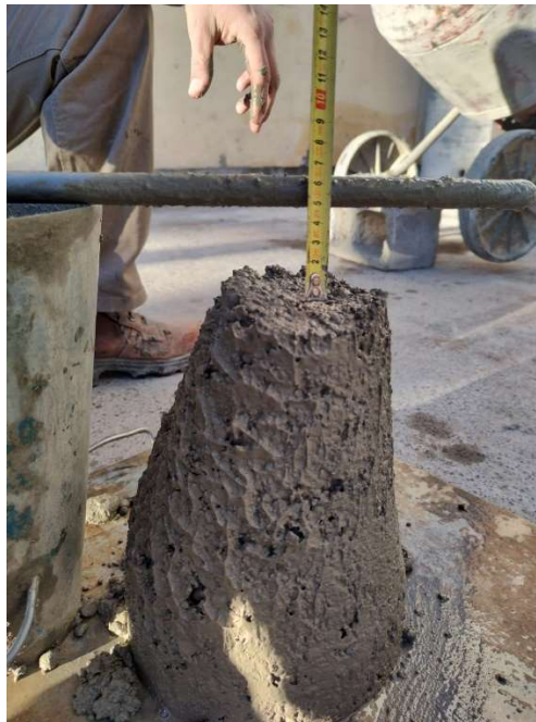
Figura 30 Ensayo de asentamiento relación a/c 0,60 (Repetición)
