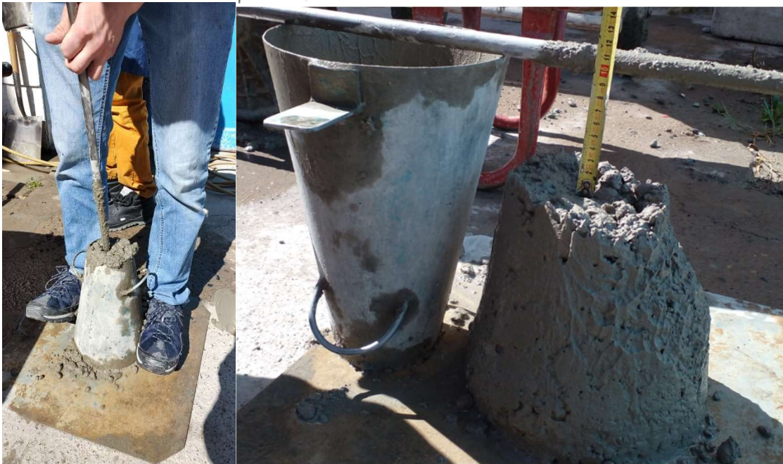
Figura 10 Ensayo de Asentamiento a/c 0,55 (Áridos sin Corregir)
