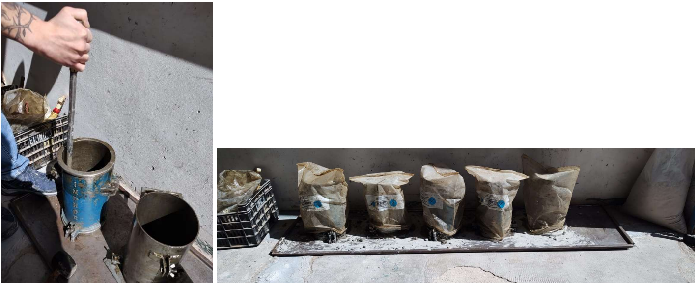
Figura 11 Procesos de fabricación probetas a/c 0,55 (Áridos sin Corregir)
