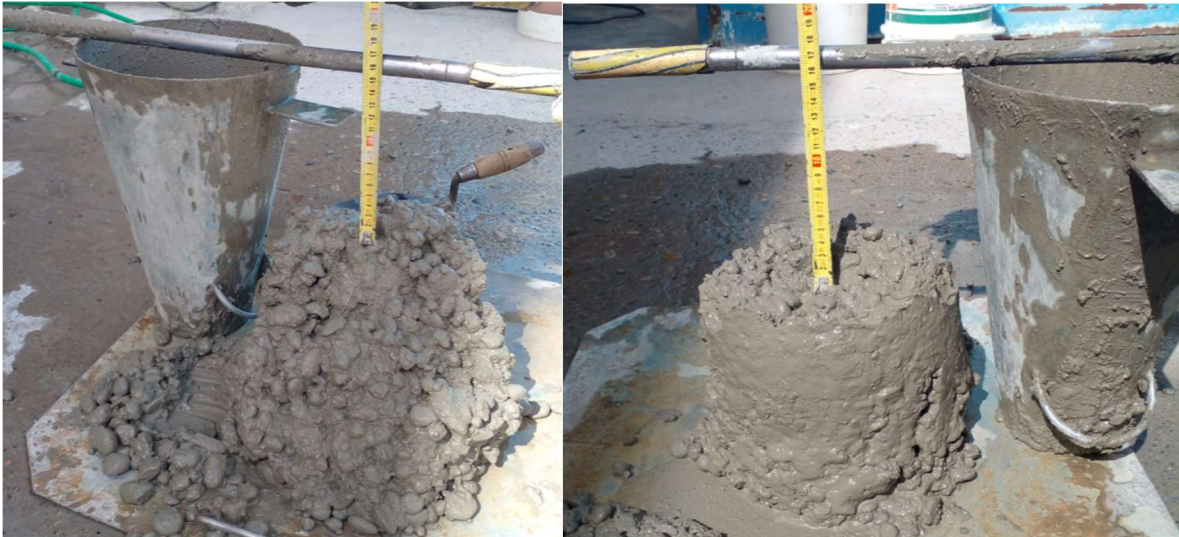
Figura 17 Ensayo de Asentamiento a/c 0,55 (árido corregido)
