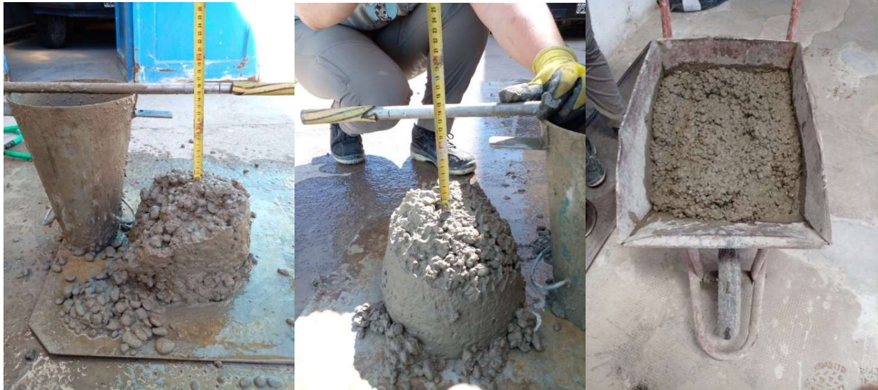
Figura 15 Ensayo de Asentamiento a/c 0,55
