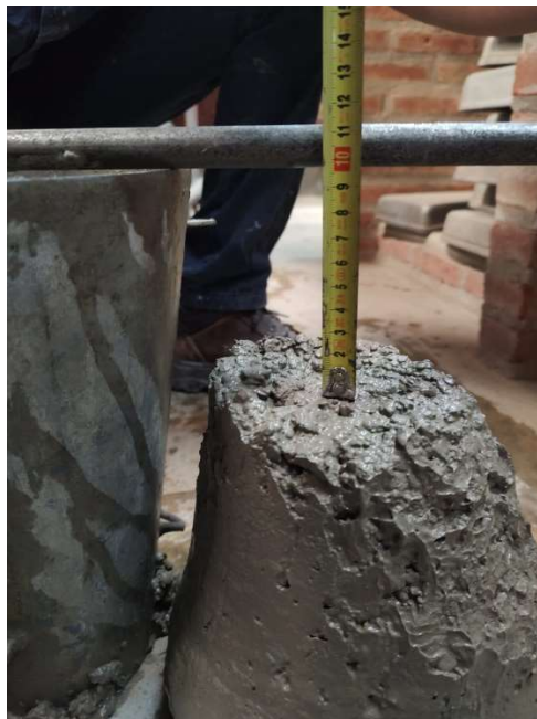
Figura 32 Ensayo de asentamiento relación a/c 0,40
