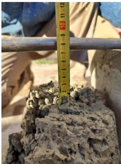
Figura 29 Ensayo de asentamiento relación a/c 0,65
