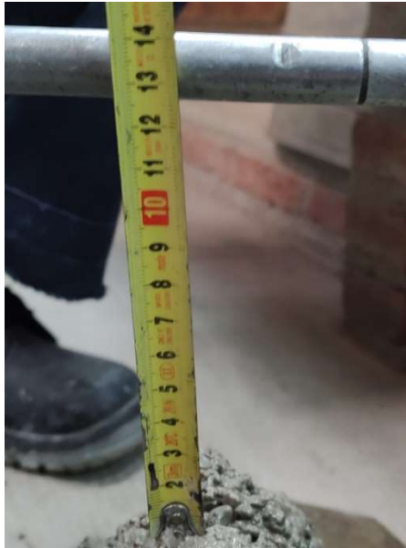
Figura 28 Ensayo de asentamiento relación a/c 0,60
