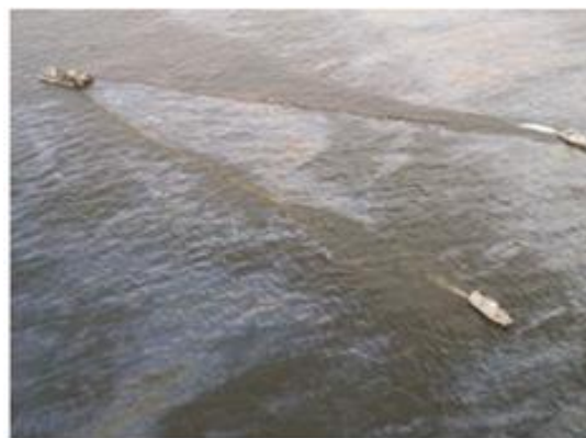
Imagen 12. Uso de una barrera de cortina con una configuración en V mediante dos remolcadores con una embarcación de recolección independiente en el vértice. (ITOPF-Promoting Effective Spill Response (f), 2022)
