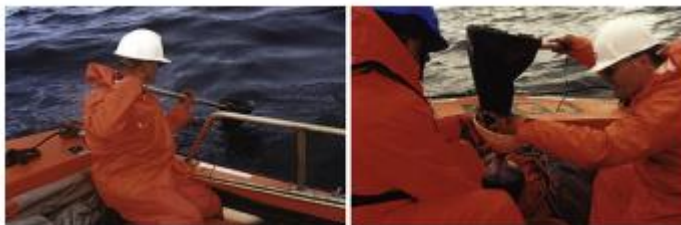
Imagen 2. Muestreo de un derrame con corneta de polietileno. En la imagen de la derecha se observa la transferencia de la muestra con un embudo para eliminar el agua libre de la emulsión. (Daling et al , 2016)
