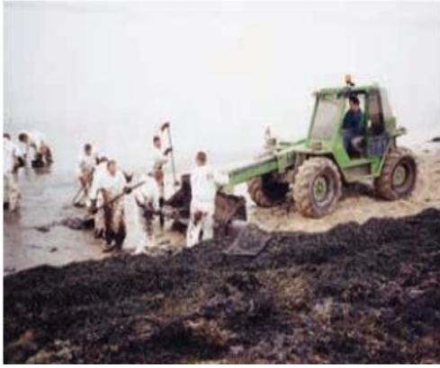
Imagen 16. Retirada manual de hidrocarburos y algas marinas contaminadas en una pala excavadora telescópica. Este método permite seleccionar el material contaminado por hidrocarburos con respecto al material limpio, lo que minimiza la cantidad de residuos. (ITOPF-Promoting Effective Spill Response (i), 2022)
