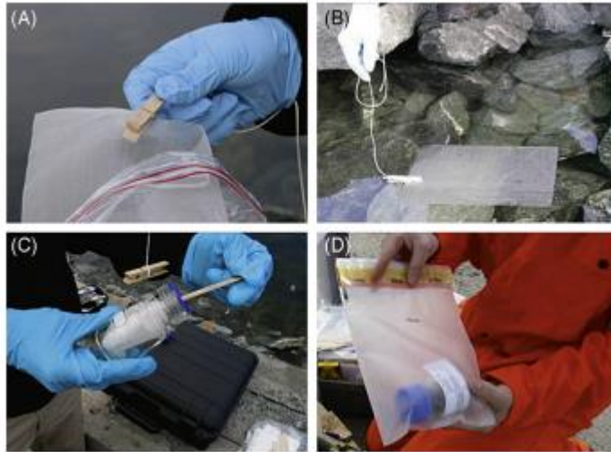
Imagen 5. Uso de red de Teflón con un broche y una línea para la toma de muestras de una película delgada de petróleo derramado. (Daling et al , 2016)
