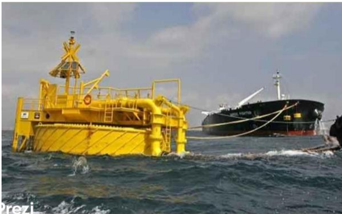
Imagen 1. Conexión de una monoboya con un buque tanque. (Buques petroleros. Operativa de carga y descarga de crudo, 2022)
