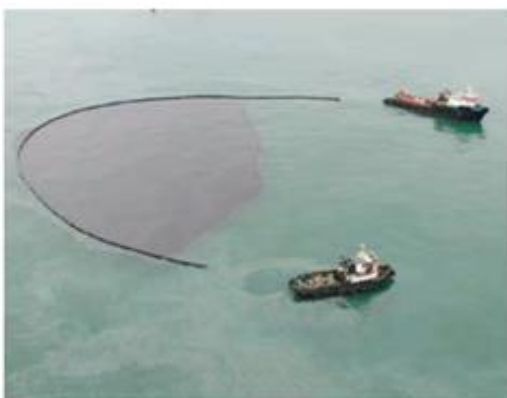
Imagen 11. Barrera inflable desplegada en una configuración en U entre dos embarcaciones para contener petróleo crudo. (ITOPF-Promoting Effective Spill Response (f), 2022)
