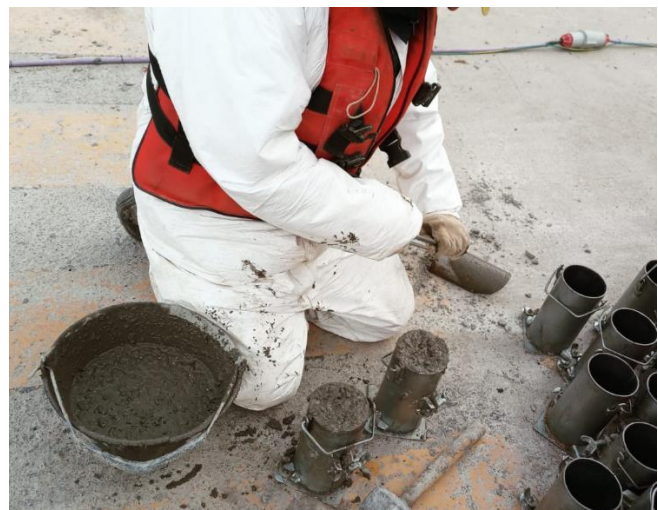
Imagen 12. Moldeo de probetas de 20cmx10cm con una muestra de hormigón de mixer.
