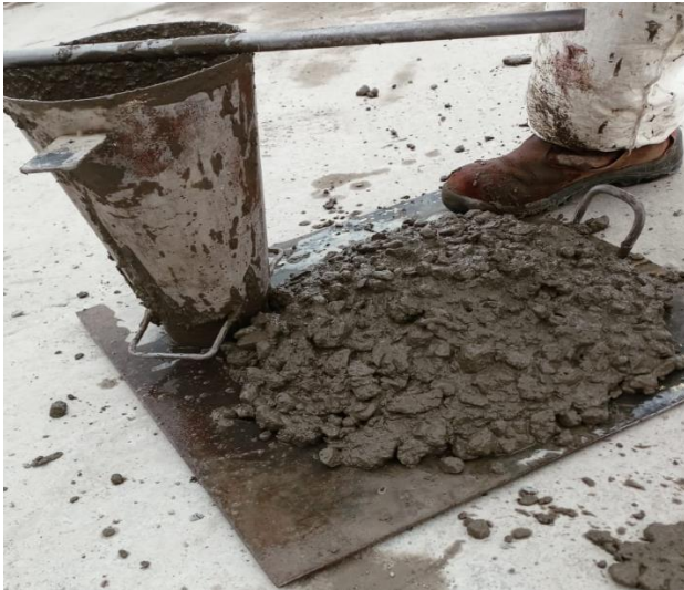
Imagen 11. Asentamiento del hormigón en obra luego de adicionado y mezclado el aditivo superfluidificante al hormigón.
