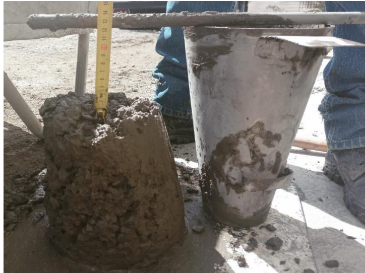
Imagen 11. Asentamiento inicial del hormigón en planta.
