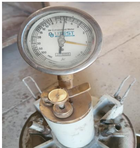
Imagen 10. Manómetro y válvulas de Washington utilizado en obra.
