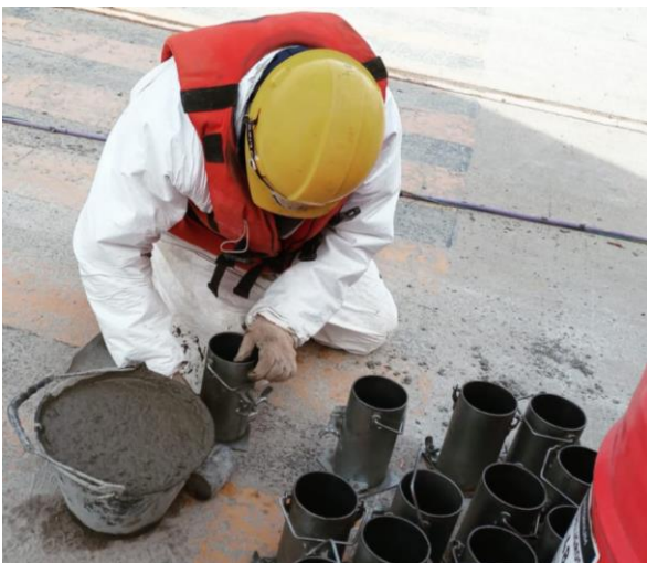
Imagen 12. Moldeo de probetas de 20cmx10cm con una muestra de hormigón de mixer.
