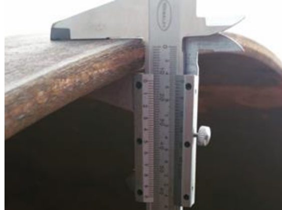
Imagen 3. Medición del espesor de camisa mediante la utilización de un calibre.
