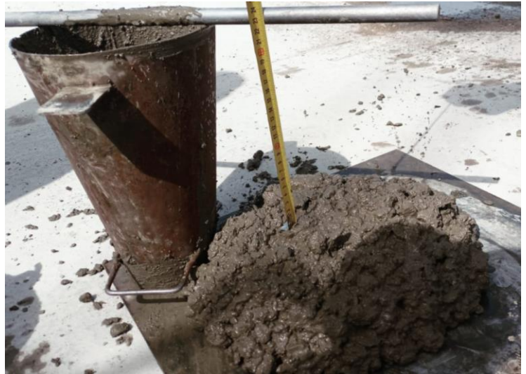
Imagen 11. Asentamiento del hormigón en obra luego de adicionado y mezclado el aditivo superfluidificante al hormigón.
