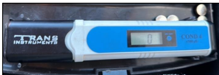
Figura 4. Conductivímetro portátil marca Trans Instruments, de alto rango de medición (salinidades > 20000 \mu\text{S} ).
