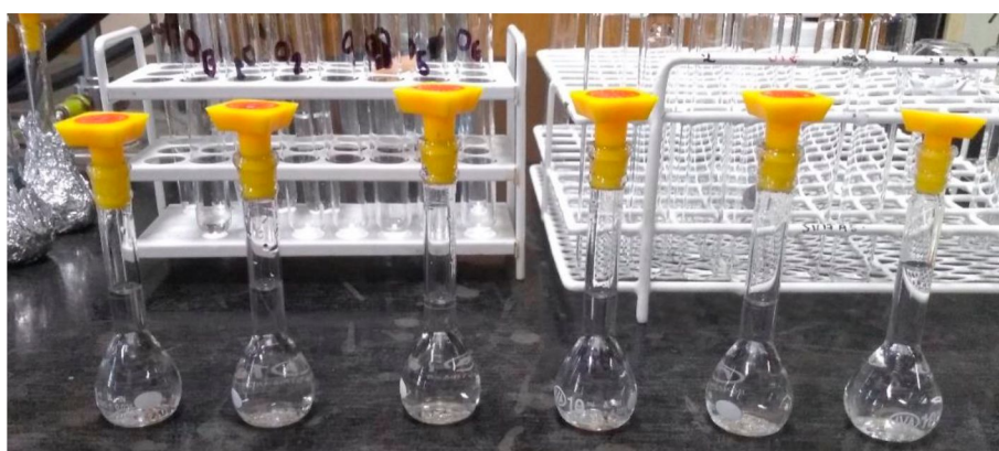
Figura 13: Serie de matraces de 10,00 ml con las diluciones de STZ para ser medidas en el espectro UV-Vis.
