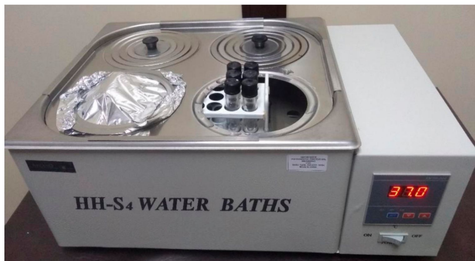
Figura 15: Soluciones a 37 °C en baño termostático para ensayo de solubilidad.
