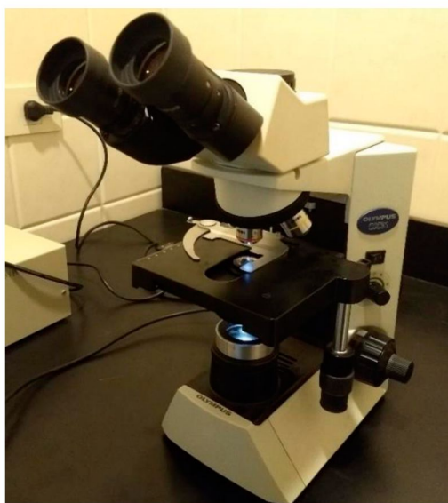
Figura 11: Microscopio óptico Olympus CX31 con filtros para polarizar la luz colocados.
