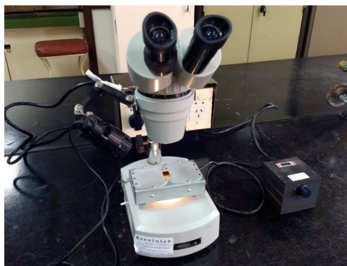
Figura 9: Lupa binocular con dispositivo de platina de calentamiento.
