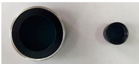
Figura 12: Filtros para polarizar la luz del microscopio óptico.
