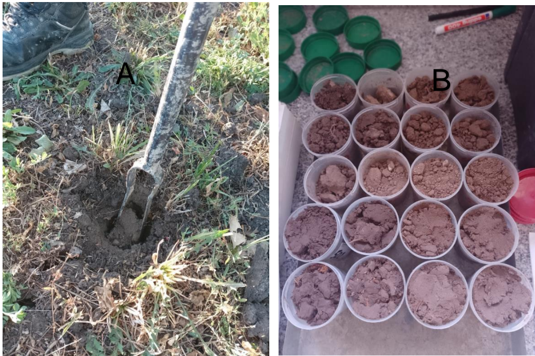
Figura nº5. A) Elemento para extraer muestras de suelo (barreno); B) Muestras de suelo secadas a estufa.
