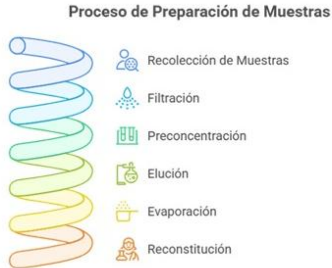
Figura 6. Representación gráfica del proceso de preparación de muestra líquida. Elaboración propia
