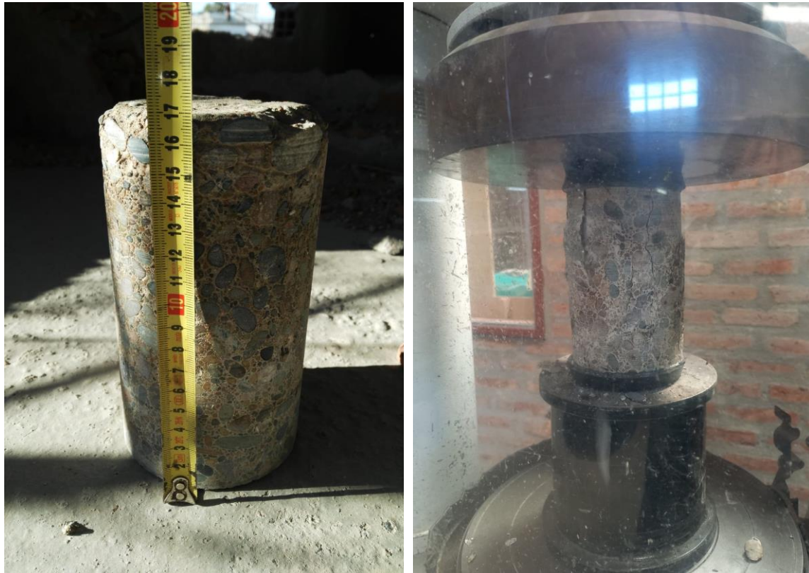
Fig. 23 Ensayo de testigos.
