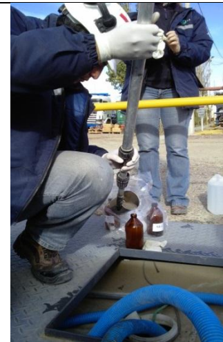
Cámara de extracción de muestra de agua, tanque de estabilización
