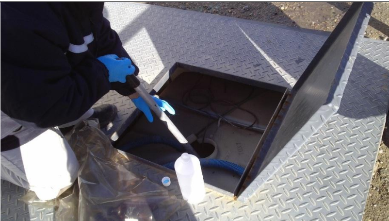
Extracción de muestra de efluente en tanque estabilizador
