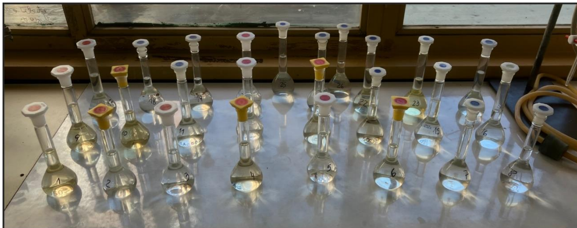
Figura 11: Extractos recolectados en matraces luego de la extracción de las bases intercambiables con acetato de amonio.
