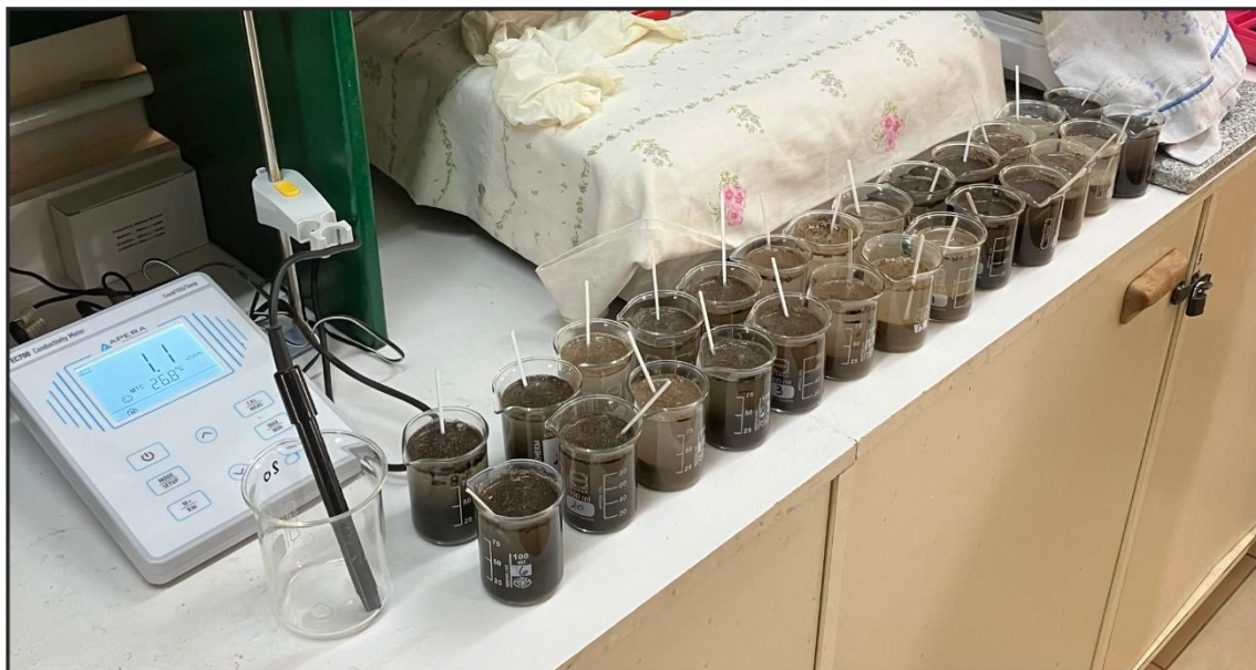
Figura 7: Determinación de la conductividad eléctrica de las muestras mediante conductímetro.
