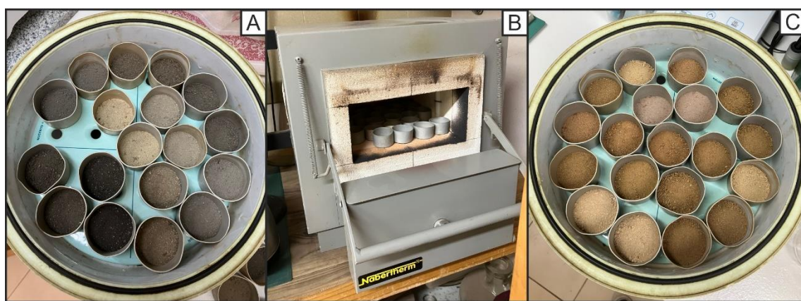
Figura 8: Determinación del contenido de materia orgánica mediante el método de Davies. A- Muestras en cápsulas antes de ingresar a la mufla. B- Muestras en la mufla. C- Muestras luego de ser retiradas de la mufla.
