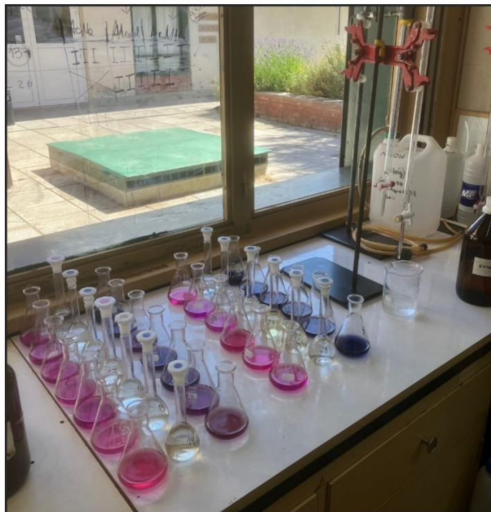
Figura 12: Matraces con los extractos preparados para la determinación de calcio y magnesio mediante titulación EDTA.
