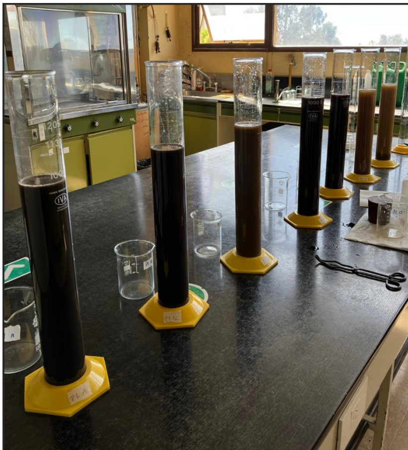
Figura 5: Determinación de la textura de las muestras mediante el método de Bouyoucos.
