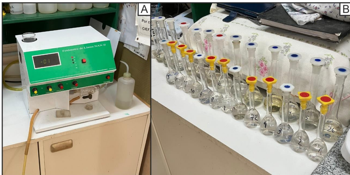
Figura 13: Determinación de sodio y potasio mediante fotometría de llama. A- Fotómetro de llama NAN II utilizado para la determinación de las concentraciones de sodio y potasio. B- Extractos diluidos empleados en el análisis.
