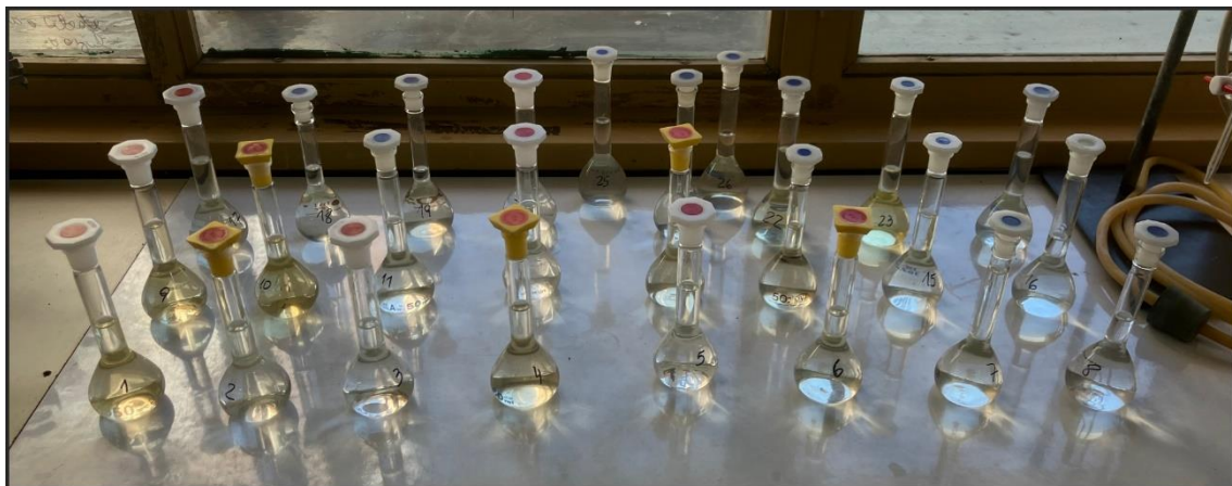
Figura 9: Extractos recolectados en matraces durante la etapa de reemplazo del sodio adsorbido por amonio en la determinación de la capacidad de intercambio catiónico (CIC).
