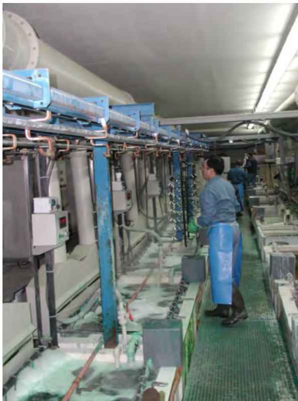
Figura 6. Imagen de una planta de niquelado, los bastidores cuelgan en baños de niquelado (CAR/PL, 2010).
