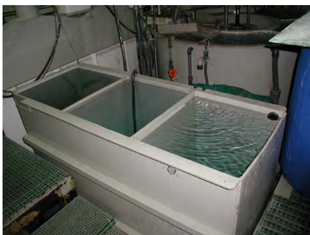
Figura 4. Imagen de un enjuagador, de doble en cascada a contracorriente (CAR/PL, 2010).
