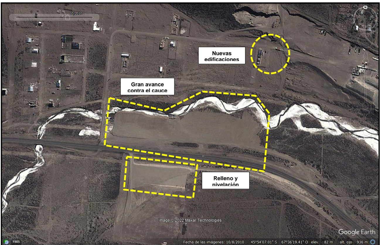
Imagen 24. (SE1) octubre de 2010. Por las marcas blancuecinas del cauce, ha habido agua escurriendo por todo el ancho del arroyo.
