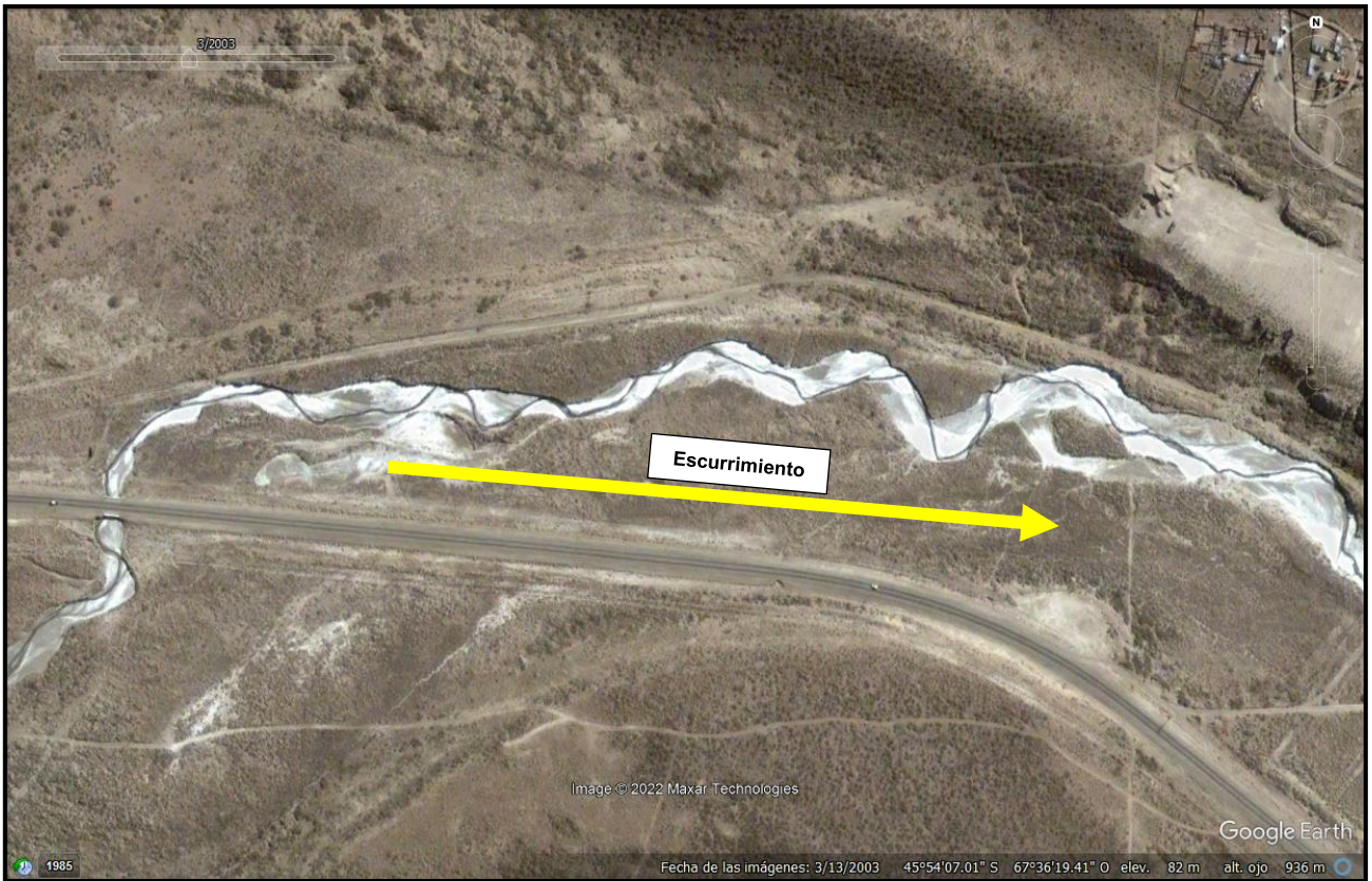
Imagen 21. (SE1) marzo de 2003. El fondo del cauce blanquecino es indicador de que ha habido flujo escurriendo recientemente y queda la marca de la evaporación de agua y restos salinos.
