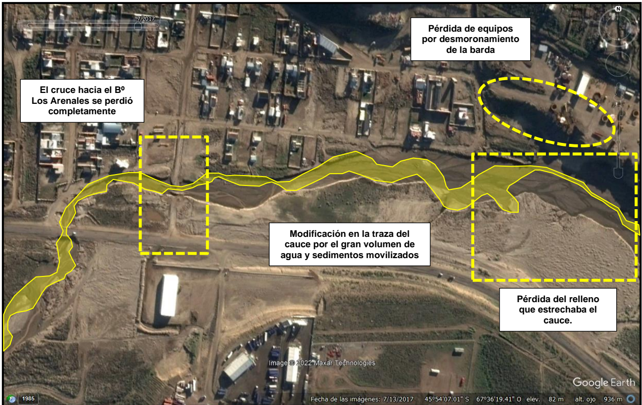
Imagen 29. (SE1) julio de 2017: estado del cauce luego del evento de precipitación (polilíneas señalando el estado del cauce previo al evento).
