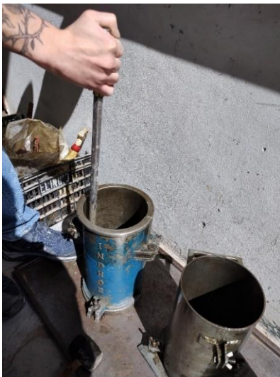
Figura 21 – Confección de probetas
