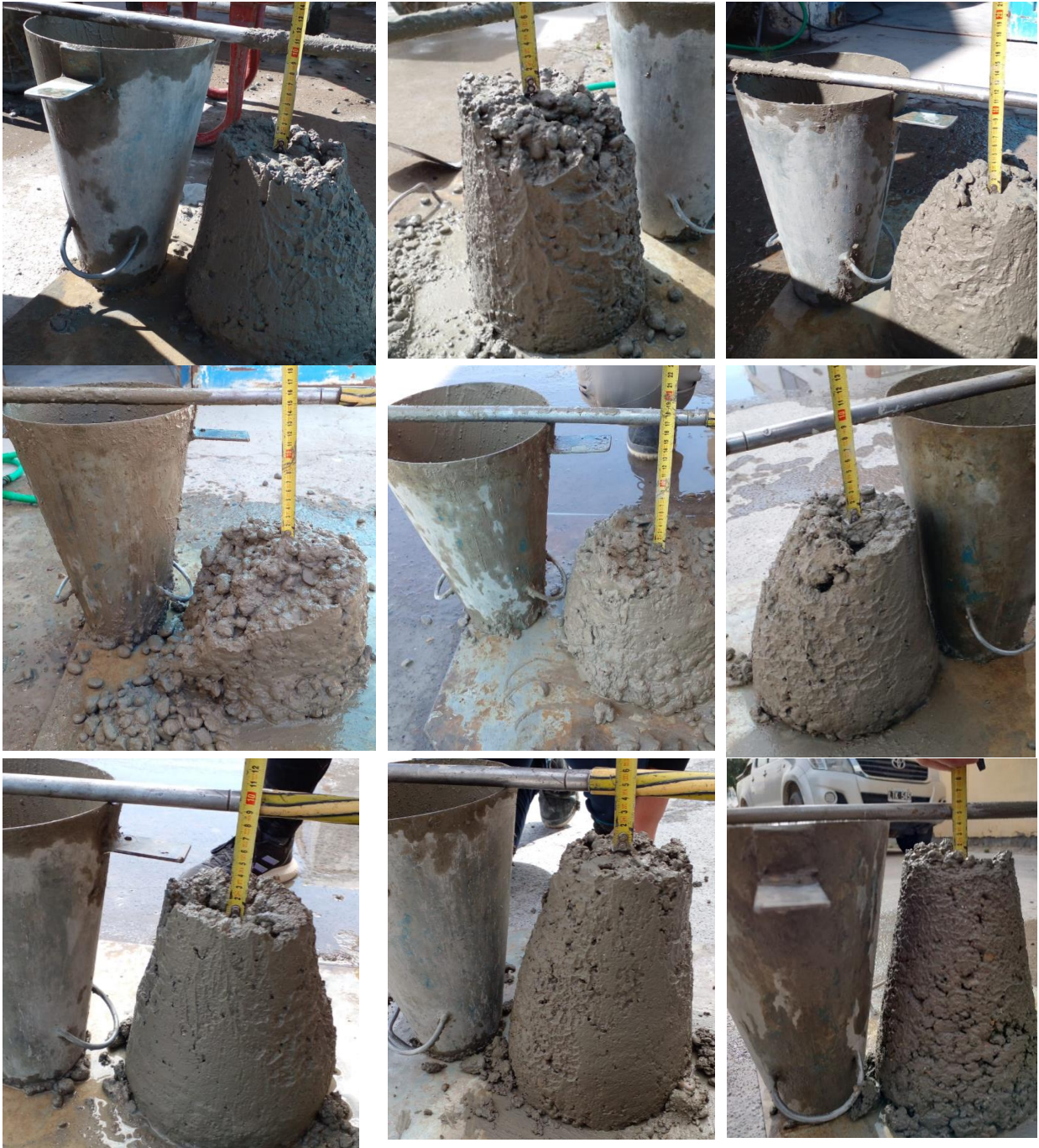
Figura 20 – Ensayos de consistencia con cono de Abrams para diferentes contenidos de agua
