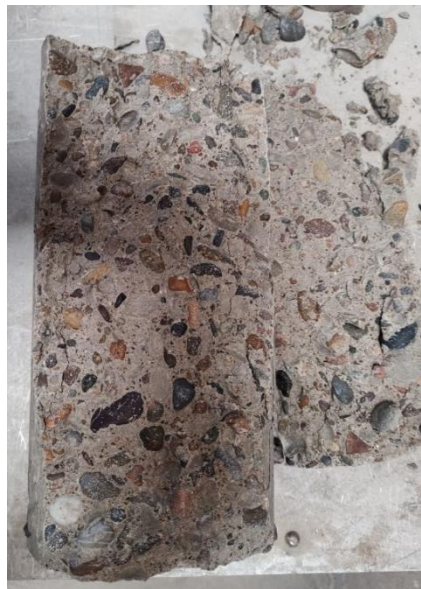
Figura 28 - Vista interior de probeta ensayada a compresión
