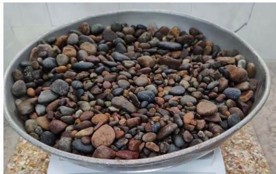
Figura 16 – Muestra saturada a superficie seca
