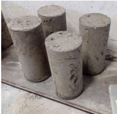
Figura 24 – Probetas desmoldadas listas para curar. Figura 25 – Probetas inmersas en solución de agua saturada con cal
