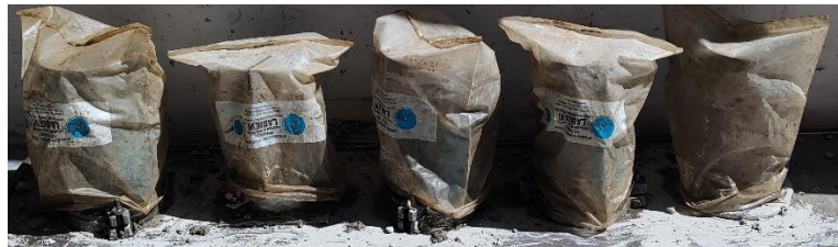
Figura 23 – Probetas con protección para mantener humedad en el proceso de fraguado
