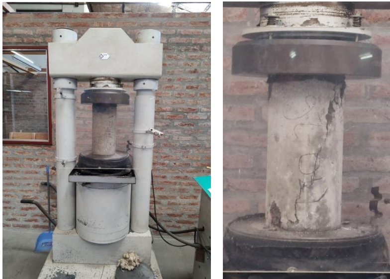
Figura 27 – Izq. Ensayo de probeta a compresión. Der. Probeta que llegó a la máxima carga que soportó.
