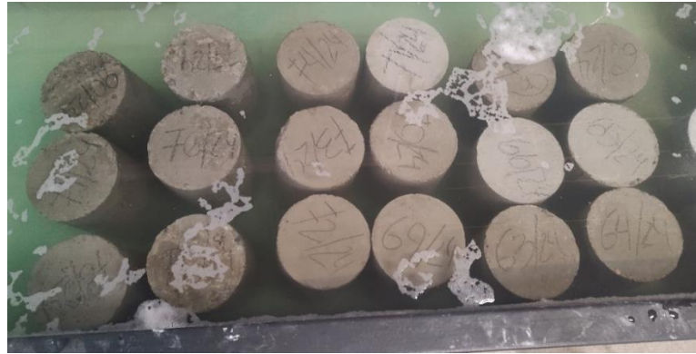
Figura 24 – Probetas desmoldadas listas para curar. Figura 25 – Probetas inmersas en solución de agua saturada con cal
