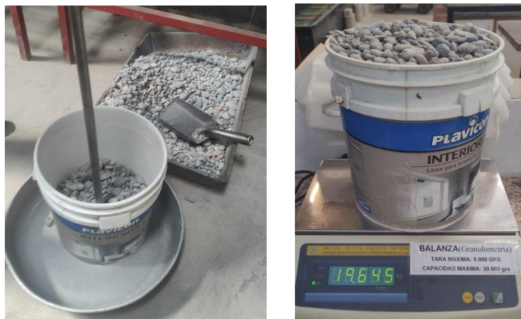
Figura 17 – Izq. Método de compactación. Der. Lectura de peso
