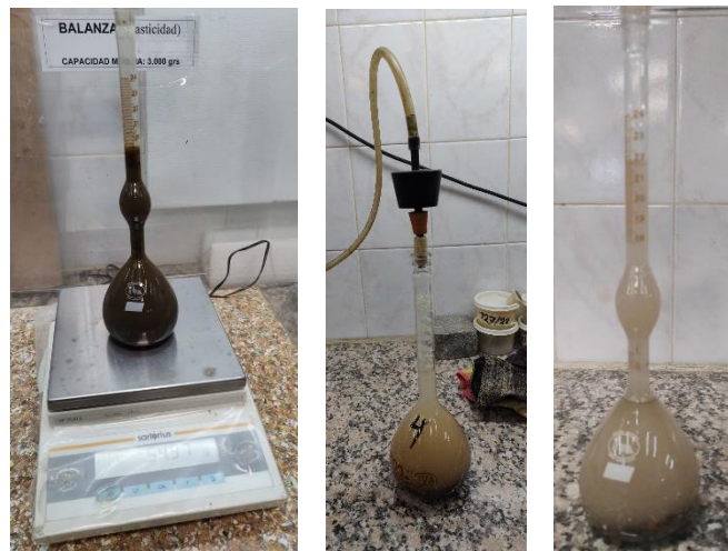
Figura 14 – De izq a der.: volumenómetro con agua + arena. Extracción de aire Atrapado. Aire expulsado de la muestra.
