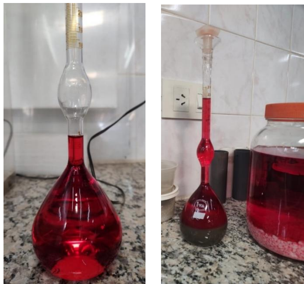
Figura 18 – Izq. Querosene en volumenómetro de Le Chatelier. Der. Querosene y cemento en volumenómetro de Le Chatelier
