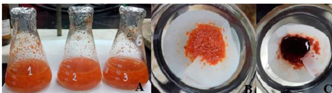
Figura 12. Determinación de nitrógeno proteico. A: Precipitación de proteínas; B y C: Filtración de proteínas precipitadas.
