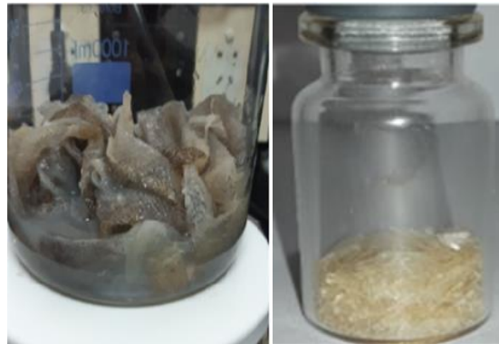
Figura 6.5 Fotografía de la piel de merluza lavada lista para la extracción y gelatina deshidratada obtenida a partir de la misma
