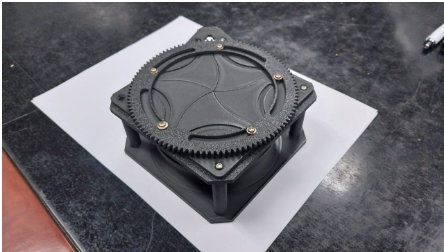
(a) Vista en perspectiva del mecanismo iris impreso cerrado
