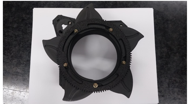
(b) Vista superior del mecanismo iris impreso abierto
