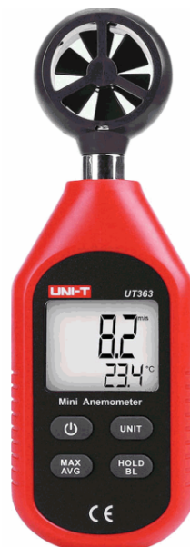
Figura 26: Anemómetro utilizado para medir el caudal de aire que circula por los ductos.
