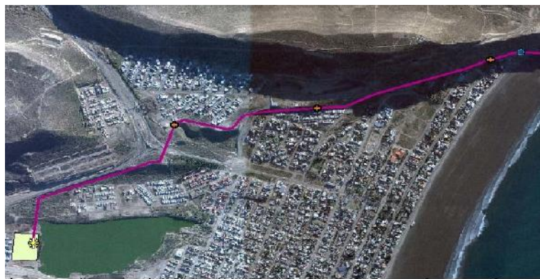
Figura 8. Proyección conducto de Impulsión (San Martín, 2017)
