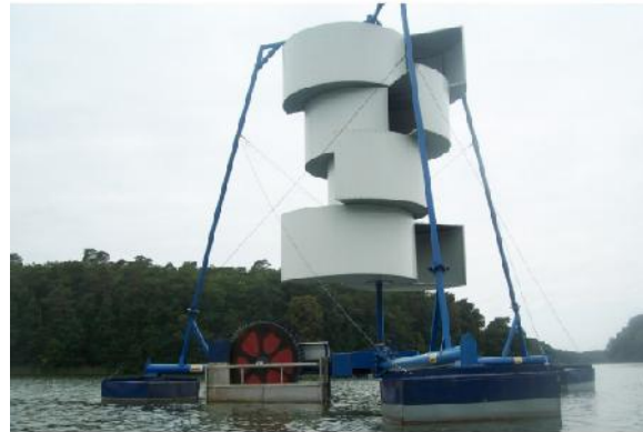
Figura 9. Sistema de Aireación Superficial mediante Turbina Eólica
