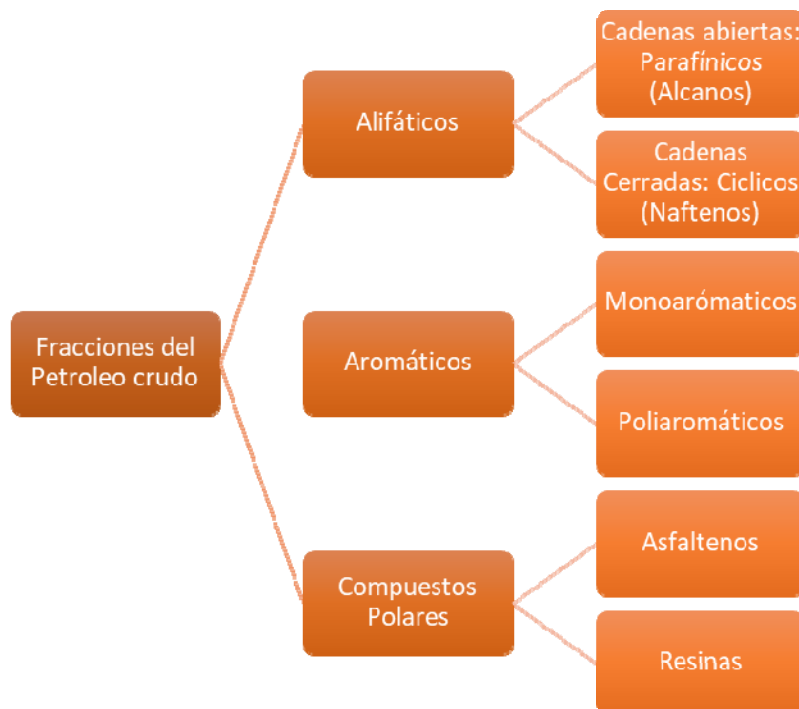
Figura N°9: Esquema de las estructuras predominantes en la mezcla de hidrocarburos del petróleo. Elaboración propia.
