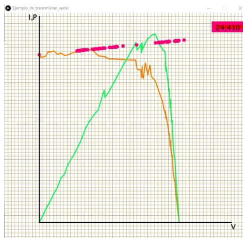
Figure 2 Graficas que muestran los rastros del punto como consecuencia de su desplazamiento debido a los ajustes que hace el algoritmo mppt
