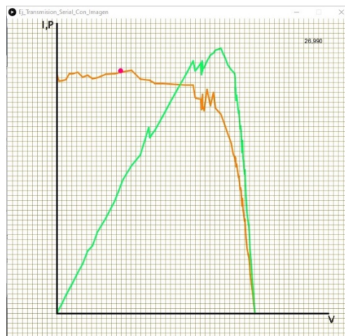
Figure 4 Grafica que muestra el desplazamiento del punto respecto a la anterior gráfica como consecuencia de una perturbación
