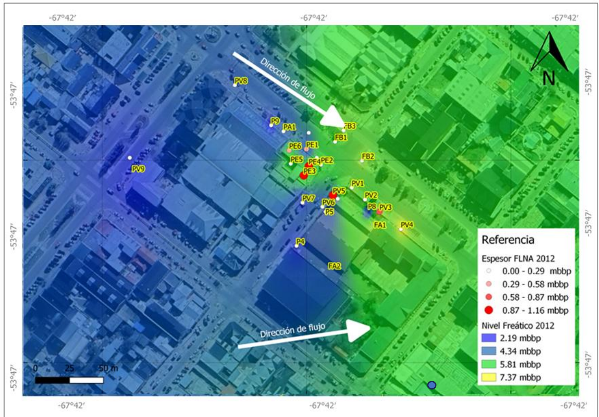
Figura N°5: Mapa del nivel freático y el espesor de FLNA en el periodo 2012.
