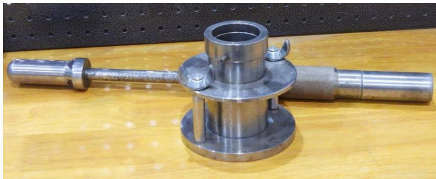
Fig.4.15- Molde y pisón del aparato Harvard miniatura
