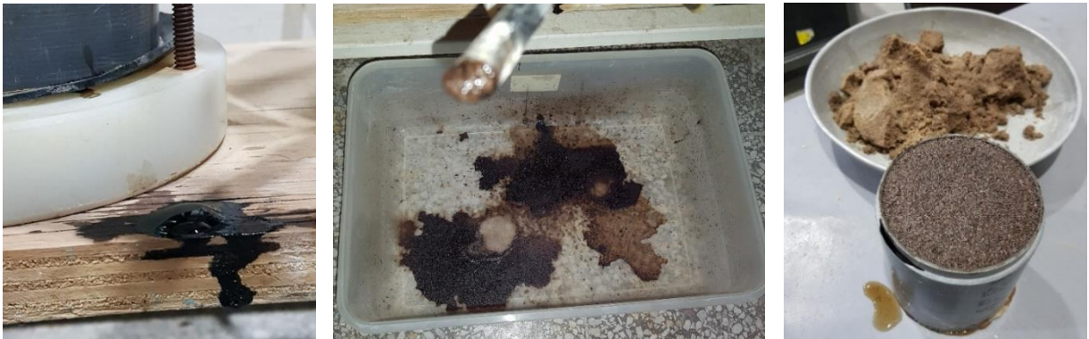
Fig.3.17- Fluidos pertenecientes a las probetas con CLS durante el ensayo de permeabilidad. Contraste entre la coloración de la arena antes y después del ensayo de permeabilidad.
