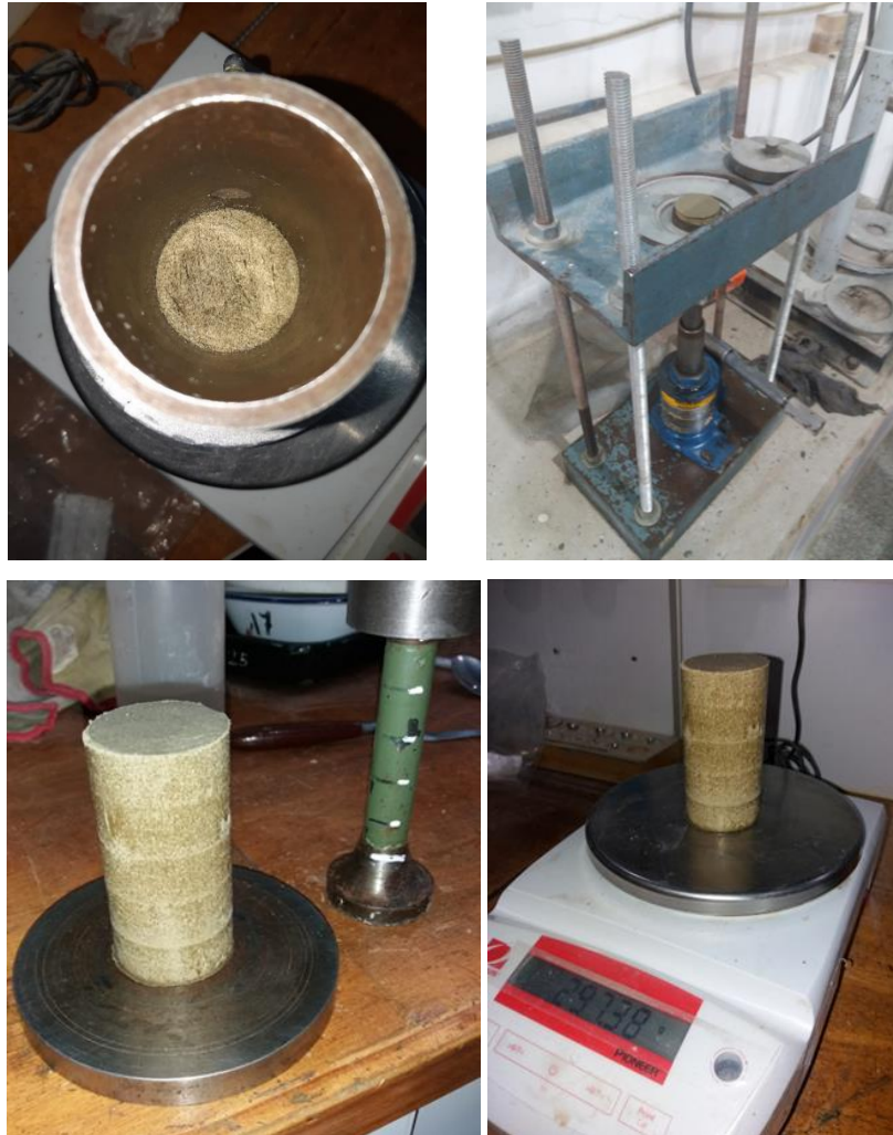
Fig.3.12- Escarificado entre cada capa, desmolde empleando gato hidráulico, probeta, registro de las dimensiones de la probeta
