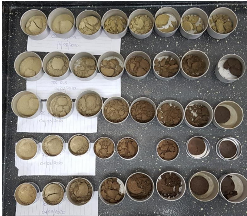
Fig.3.21- Determinación de humedad de las muestras empleadas para las curvas de saturación de CRclay (de arriba hacia abajo CRclay, 3%, 5%, 7% y 10%CLS, de izquierda a derecha de menor a mayor porcentaje de humedad).
