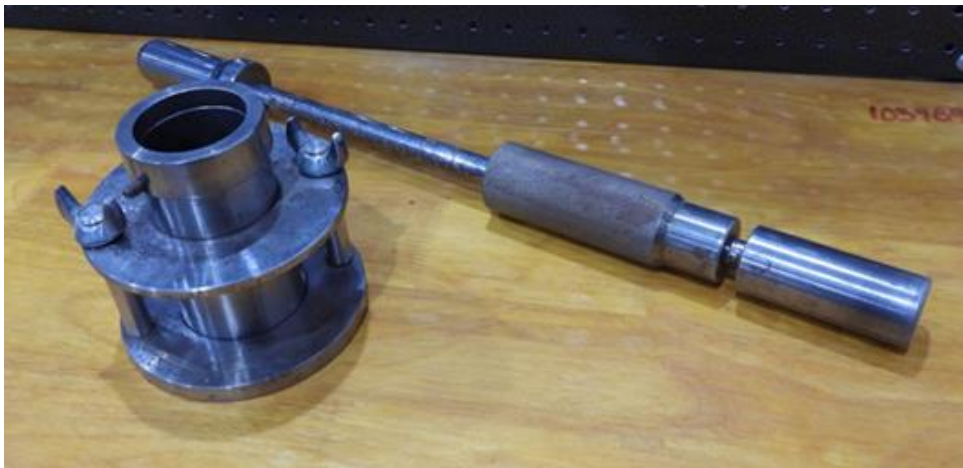
Fig.3.1- Molde y pisón del ensayo de compactación Harvard Miniatura
