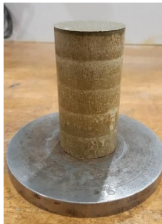
Fig.3.2- Probeta típica obtenida mediante la compactación con el molde Harvard Miniatura.
