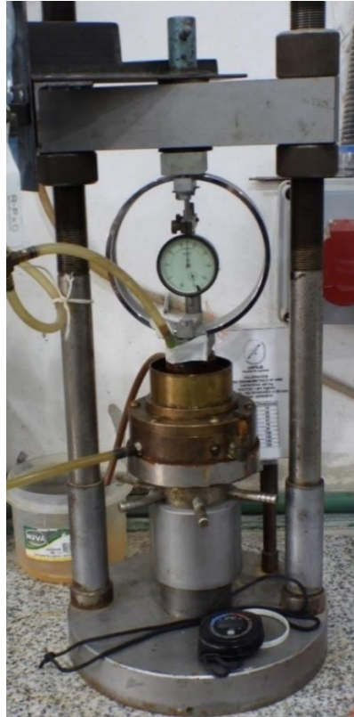
Fig.3.9- Aparato de Lambe con aro dinamométrico: método directo para determinar la presión de hinchamiento.
