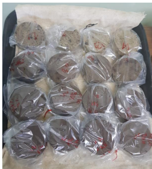
Fig.3.6- Probetas con diferentes porcentajes de CLS preparadas para ensayos a diferentes edades.
