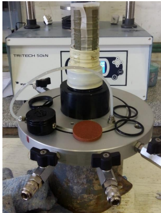
Fig.3.14- Drenes verticales colocados en las probetas para facilitar el drenaje.
