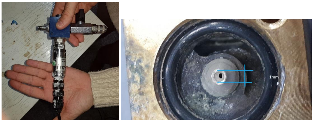
Fig.3.15- Sales depositadas en uno de los sensores de presión de una de las líneas de la cámara triaxial. Depósitos salinos en una imagen magnificada de la misma válvula.
