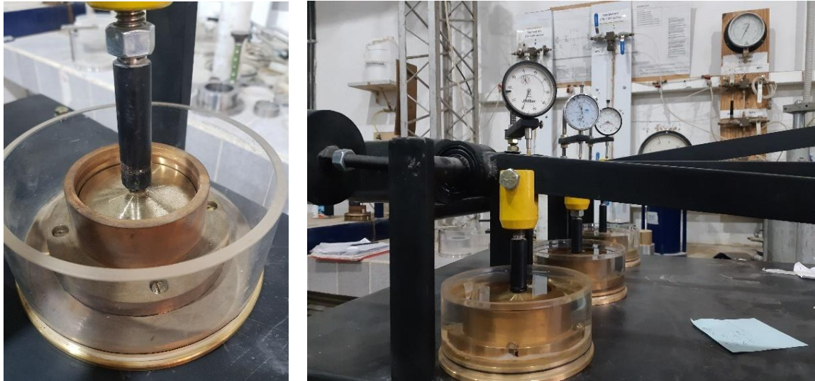
Fig.3.7- Celda edométrica y bancada en la que se realizaron los ensayos de expansión libre
