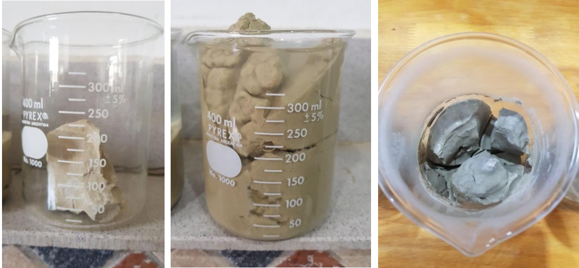
Fig.1.2- Terrón en condición natural (izq.), terrón totalmente expandido luego de cinco días de inmersión en agua desmineralizada (centro), terrón con grietas de tracción luego de dos meses expuesto al aire (FRclay)
