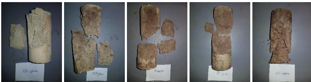
Fig.4.59- Rotura a la compresión simple de probetas de la misma edad (9 meses) y diferentes porcentajes de CLS
