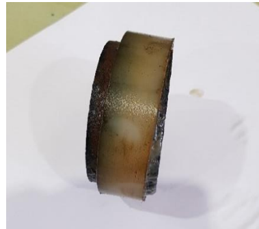
Fig.3.8- Probeta malograda por sobrepasar el espesor del anillo dentro del que se encontraba posicionada durante el ensayo de expansión libre.
