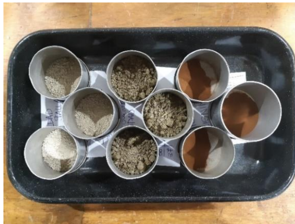
Fig.3.5- Verificación de humedad de CRclay y CLS
