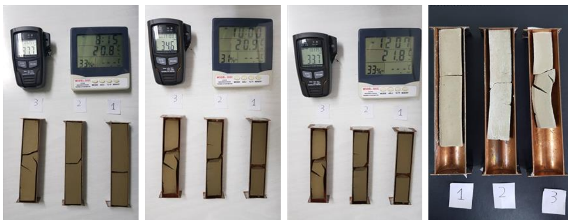
Fig.4.7- Índice de contracción lineal (LC). Suelos CRclay (1), GAclay (2), FRclay (3)
