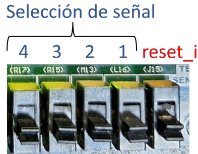
Figura 5.9: Selección de la señal a transmitir por medio de interruptores en la Nexys 4 DDR.
