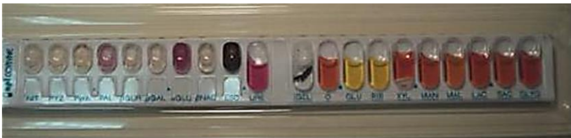
Figura 20: Galería API Coryne. Sistema estandarizado para identificación de bacterias corineformes.
