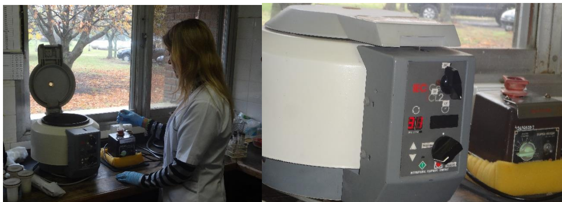
Figura 6: Centrifugación en la saponificación y esterificación de la muestra.
