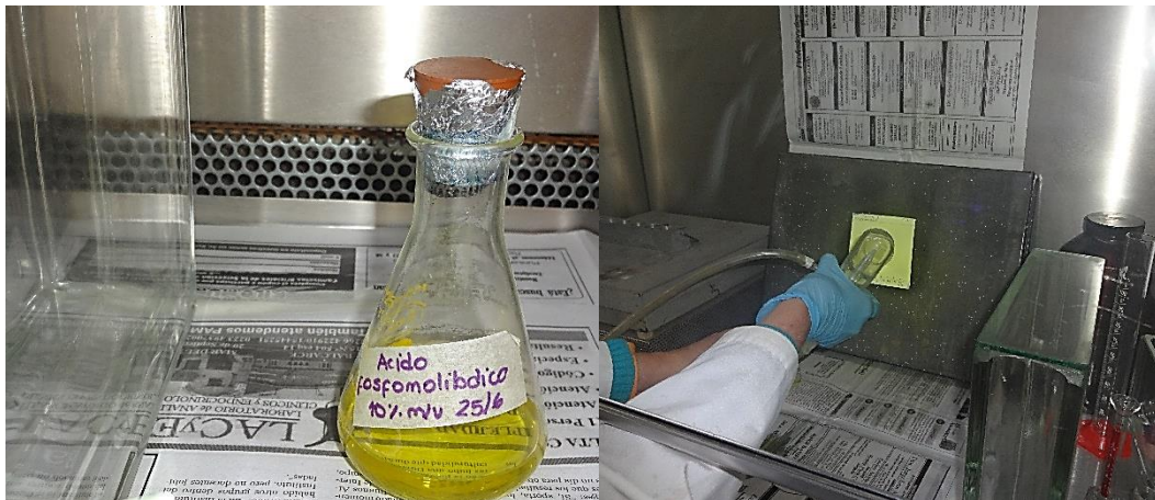
Figura 9: Revelado con ácido fosfomolibdico al 10 % (p/v) en etanol bajo campana.
