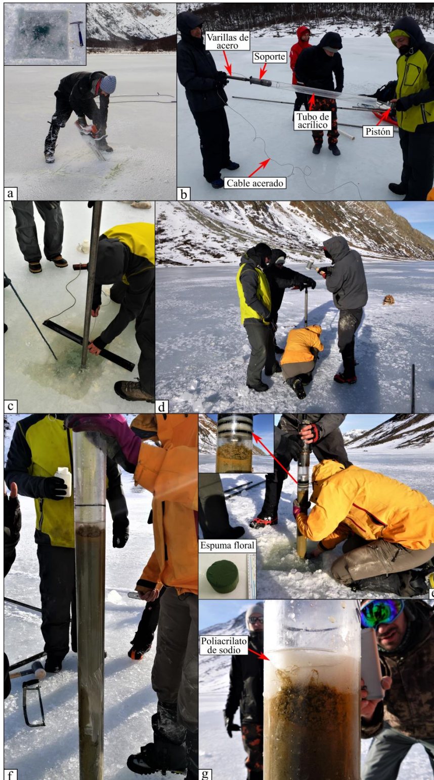
Figura IV.6: (a) Perforación con motosierra del hielo superficial de la laguna, en detalle se muestra el orificio generado. (b) Armado del muestreador en campo. (c) Sujeción en superficie del cable acerado que se conecta al pistón para que este último quede en posición estática. (d) Hincamiento del muestreador mediante golpes con martillo de teflón. (e) Extracción del muestreador con sedimentos del fondo de la laguna y colocación de espuma floral (en detalle) en la base del testigo, también se muestra detalle del techo del testigo, interfase agua-sedimento y pistón. (f) y (g) Agregado de poliacrilato de sodio y gelificación del mismo en contacto con el agua.
