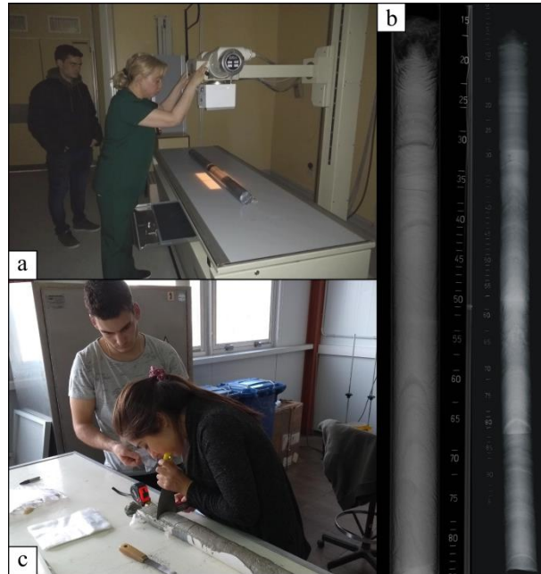
Figura IV.7: (a) Obtención de imagen de rayos X por personal del Hospital Regional Ushuaia. b) Imágenes de rayos X de los testigos. c) Submuestreo de la media caña de unos de los testigos.
