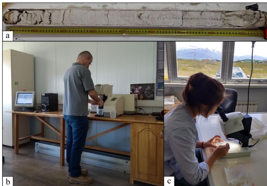
Figura IV.8: (a) Testigo seco con las marcas dejadas por la extracción de sedimento para el análisis textural. (b) Técnico Ignacio Magneres (CADIC-CONICET) operando el sedígrafo. (c) Recolección de materia orgánica para realizar las dataciones.
