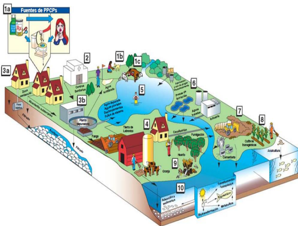
Figura 1: Contaminación por PPCPs: fuentes y ecosistemas afectados: [1] Uso doméstico: (1a) Personas, (1b) Mascotas. Fuentes de PPCPs: Excreción del organismo (sustancias no metabolizadas o metabolitos), vertido incontrolado de medicamentos al desagüe, filtración al subsuelo desde el sistema de alcantarillado, (1c) abandono de cadáveres de animales que sirven de alimento
