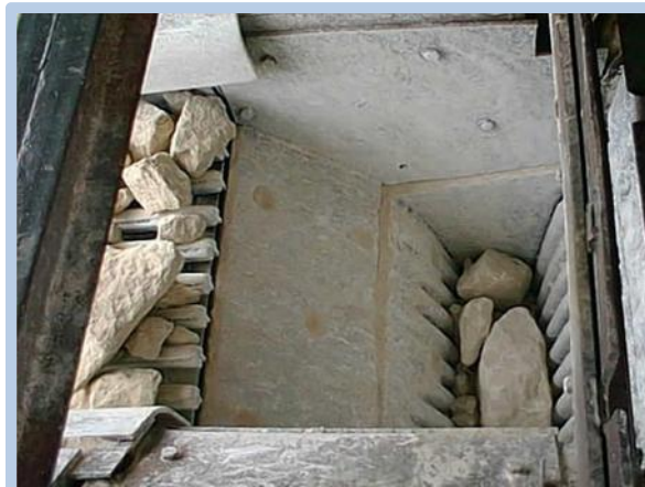
Figura 3.3 Trituradora de mandíbulas-trituración primaria
