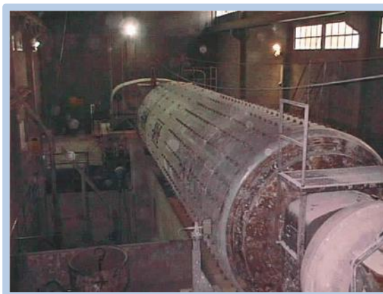
Figura 3.6. Molino de bolas en Planta.
