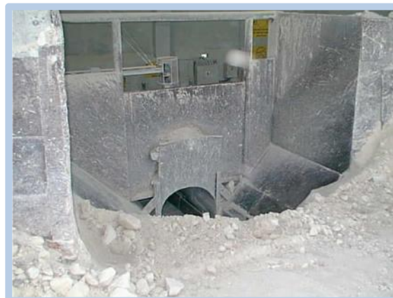
Figura 3.5. Trituradora de martillo – trituración secundaria
