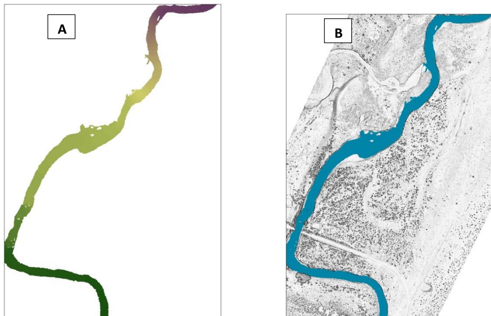
Figura 21. A) Raster obtenido del software IBER. B) Raster importado a ArcGis sobre el modelo digital del terreno.
