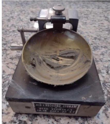
Figura 12. Cuchara de Casagrande utilizada en el ensayo.
