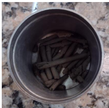
Figura 13. Ensayo para determinar limite plástico.
