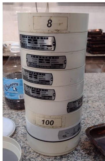
Figura 9. Tamizado por vía húmeda tamiz #200.
