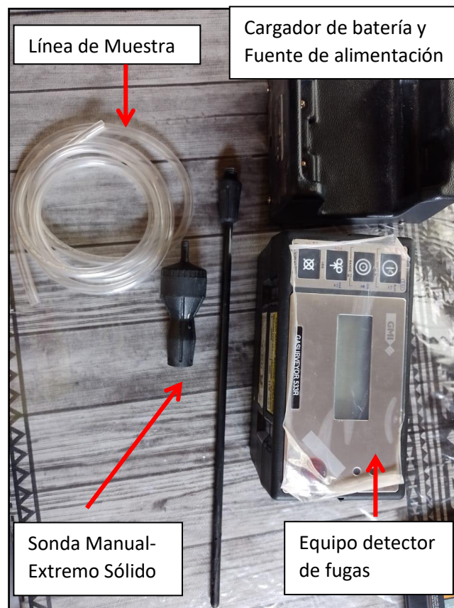
Imagen N°17: Equipo Exposímetro y sus partes componentes.
