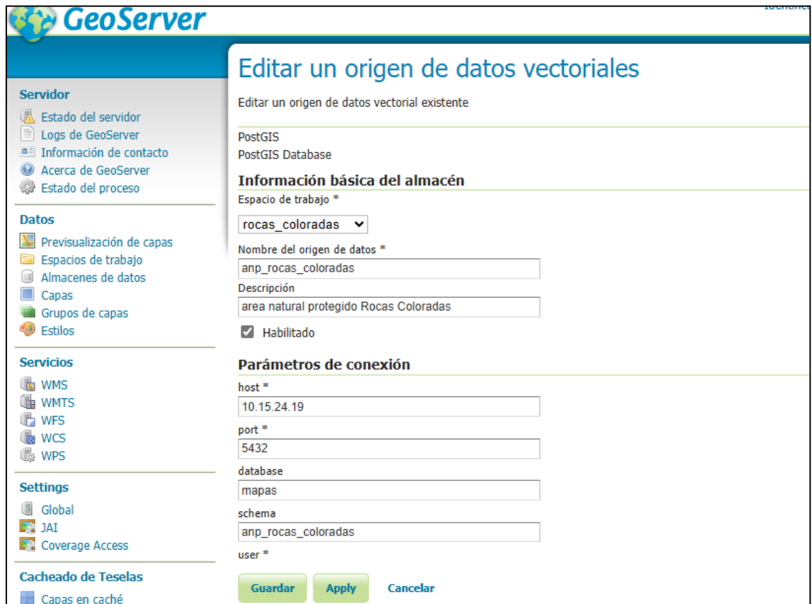
Figura 16: Vista de la conexión a la base de datos Postgis en GeoServer.
