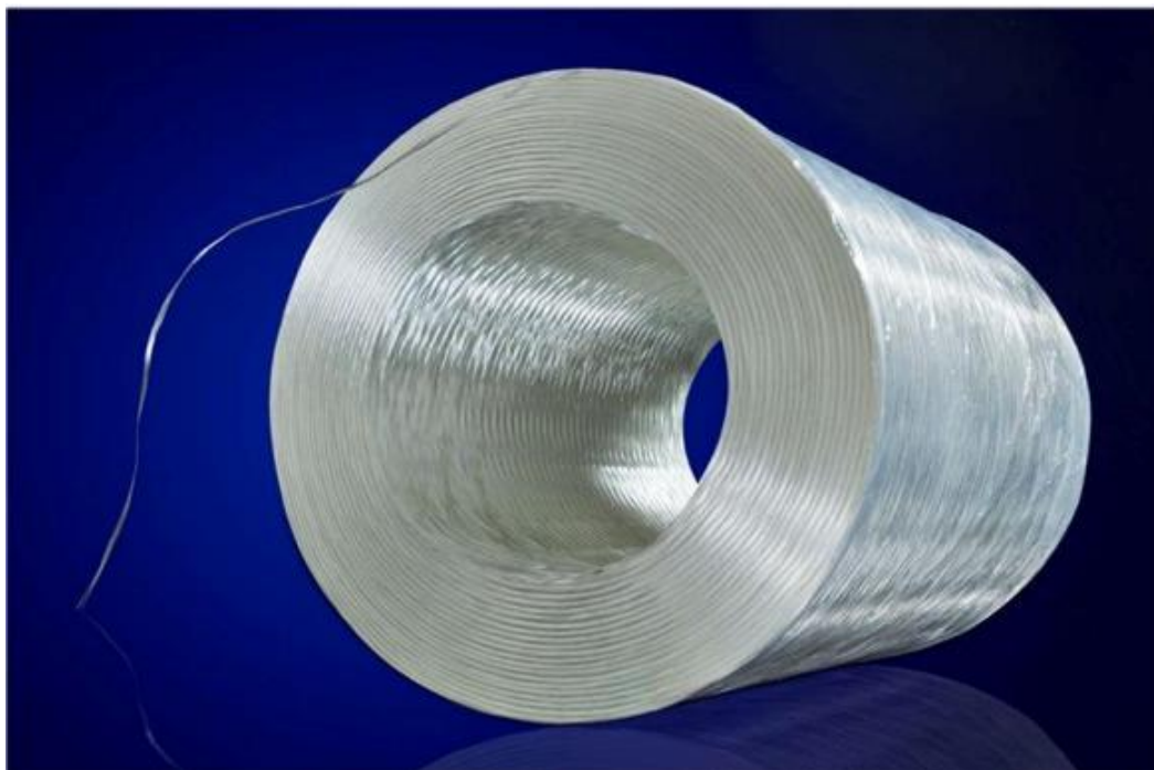
Figura 9. HALOS FIBRA DE VIDRIO. FUENTE: TOLEDO 2015
