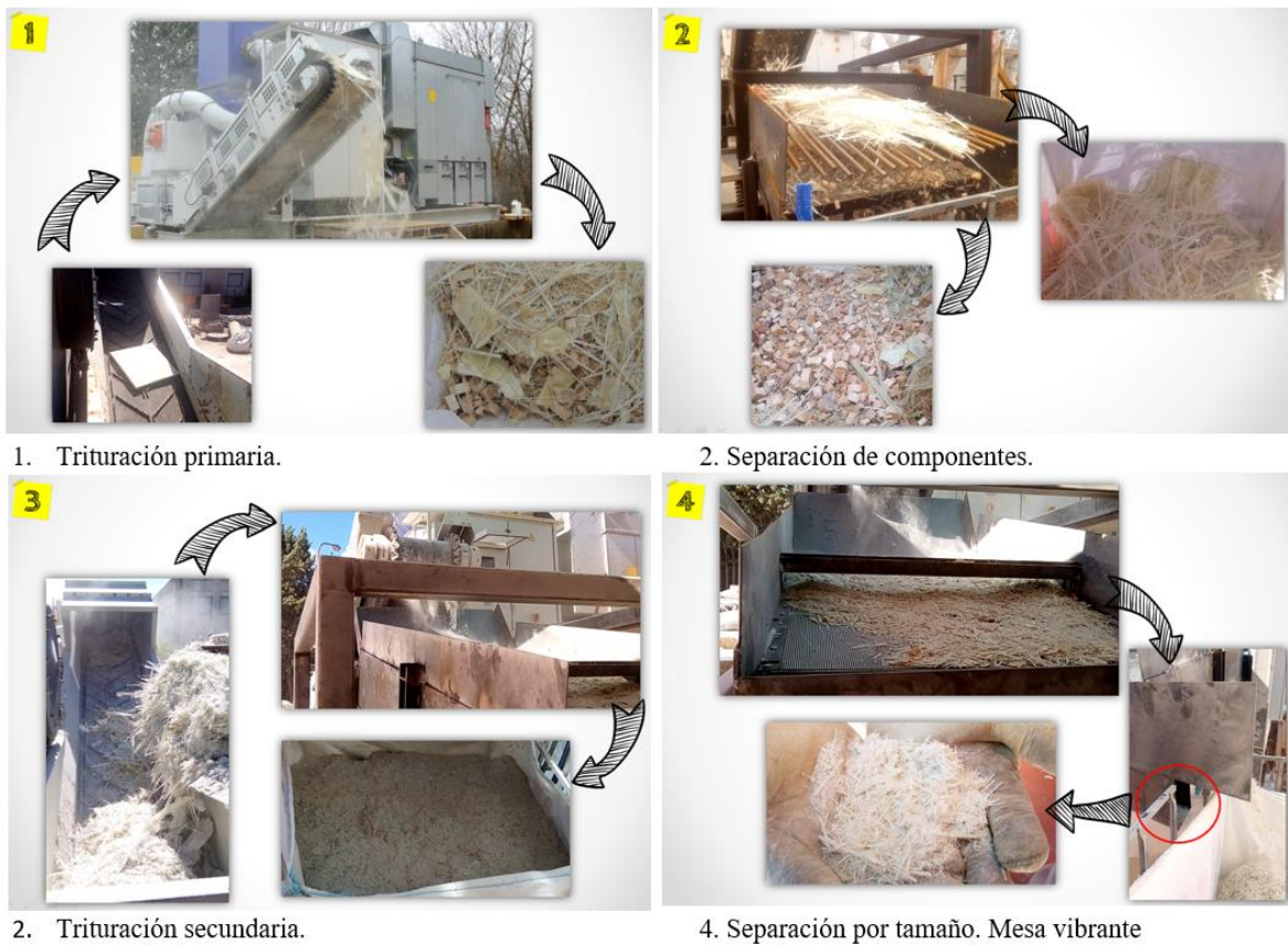
Figura 17. PROCESO DE SEPARACIÓN DE LOS COMPONENTES DE UNA PALA EÓLICA. FUENTE: LIFE REFIBRE. HTTPS://WWW.LIFEREFIBRE.EU/
