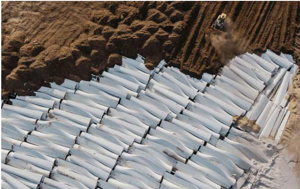
Figura 6. PALAS DE AEROGENERADORES EN VERTEDERO REGIONAL DE CASPER. FUENTE: WORL ENERGY TRADE, CONSULTADO EN HTTPS://WWW.WORLDENERGYTRADE.COM/ENERGIAS-ALTERNATIVAS . CONSULTADO 21/08/2023.
