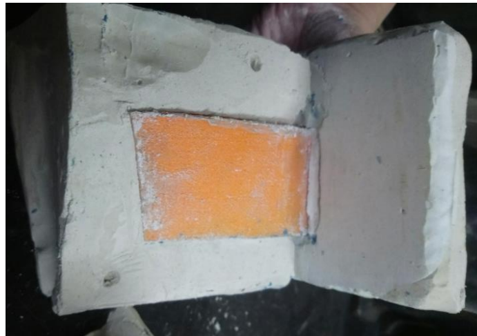
Figura 85 Esquema de molde en tres partes
