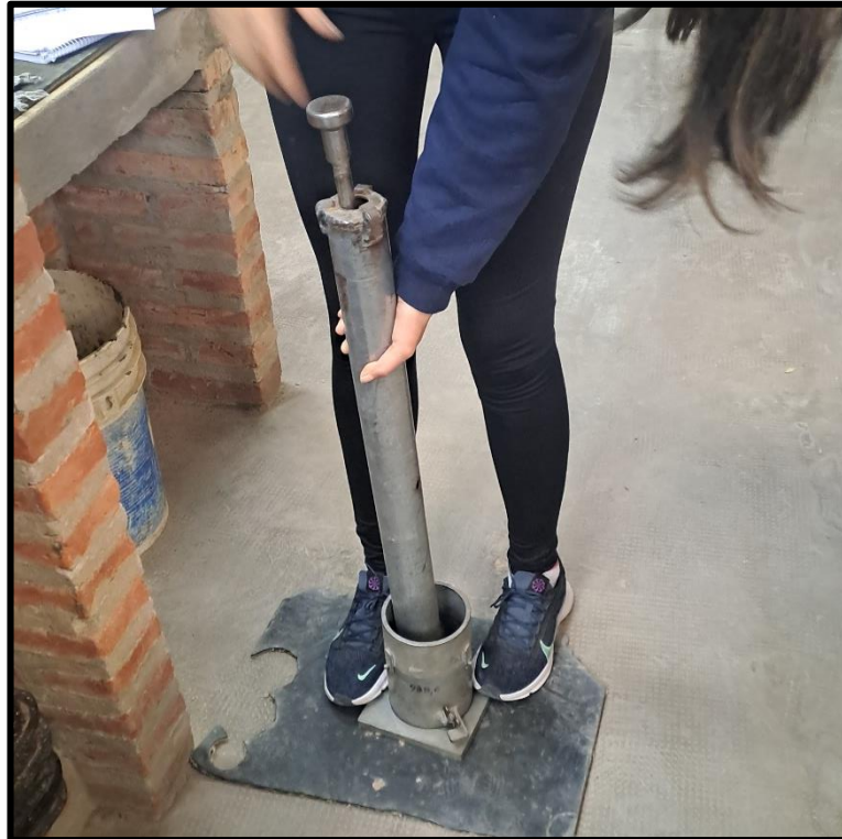
Imagen 21: Compactación de probetas con pisón.
