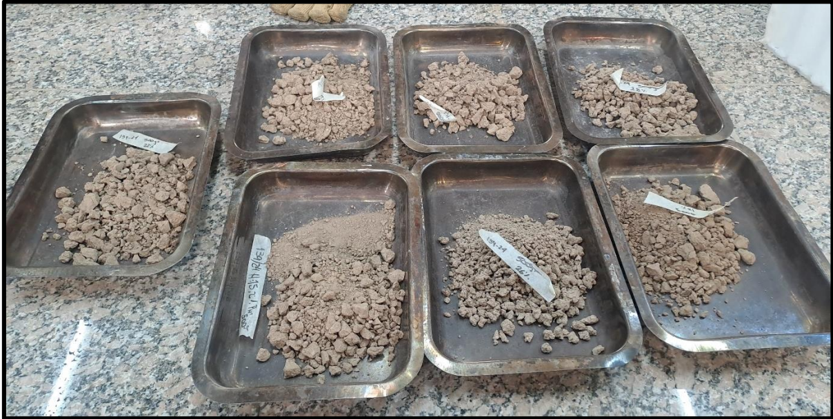
Imagen 25: Muestras de suelo 139-24 secadas hasta peso constante.
