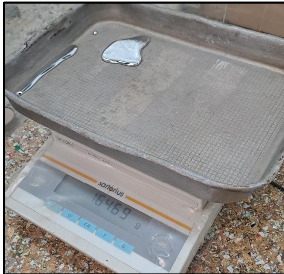
Imagen 15: Pesaje de mercurio desplazado por la pastilla de suelo.
