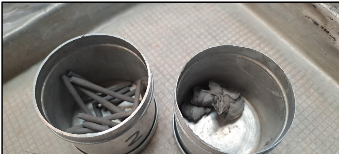
Imagen 11: Pesafiltros con muestras para límite plástico (izquierda) y líquido (derecha).
