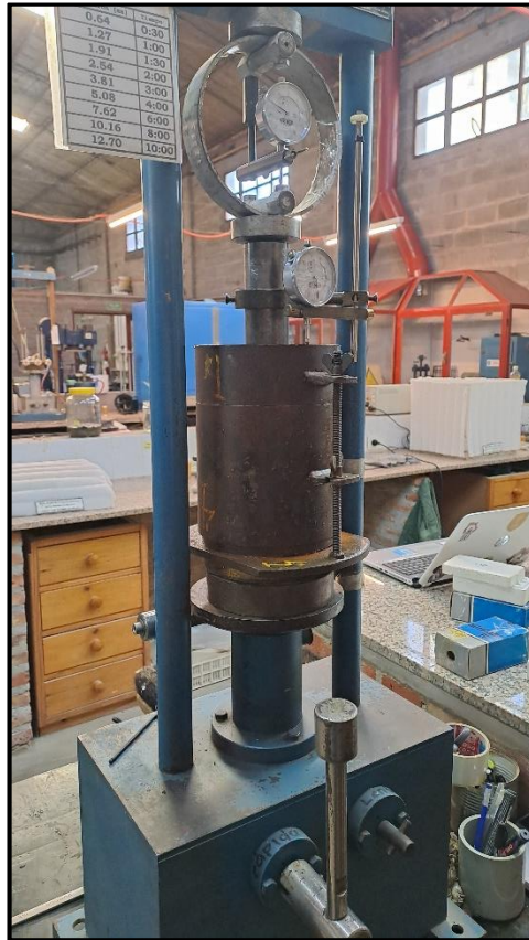
Imagen 32: Prensa preparada para ensayar penetración sobre una probeta.
