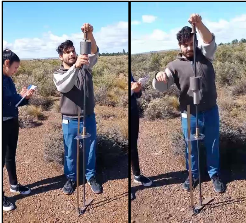
Imagen 55: Operación del DCP Izq. Elevación de la masa Der. Caída de la masa (Fuente: Elaboración propia).
