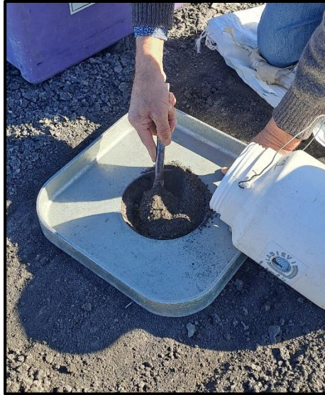
Imagen 49: Excavación del hoyo y retiro de material.
