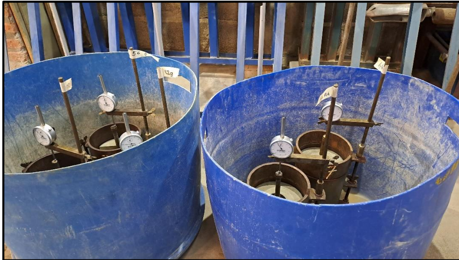
Imagen 31: Moldes preparados para ser sumergidos en agua.
