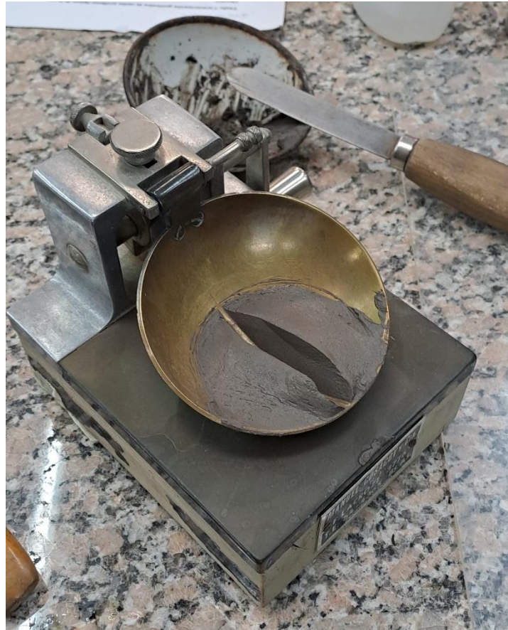
Imagen 8: Colocación de muestra en la Cuchara de Casagrande (Fuente: Elaboración Propia).
