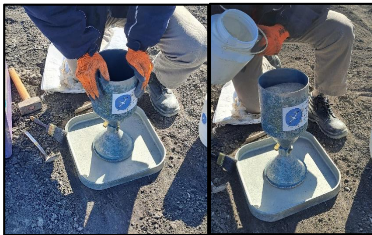
Imagen 50: Izq. Colocación del cono en la bandeja Der. Colocación de la arena en el cono.
