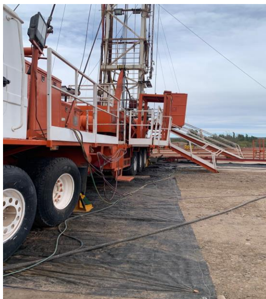
Figura N° 38. Equipo de Pulling. Mantas debajo de equipo
