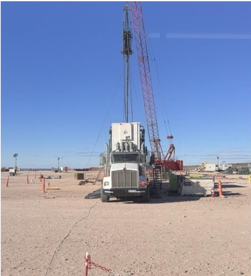
Figura N° 27: Equipo de coiled tubing. Compañía Calfrac. Fuente: Elaboración propia. (2025)
