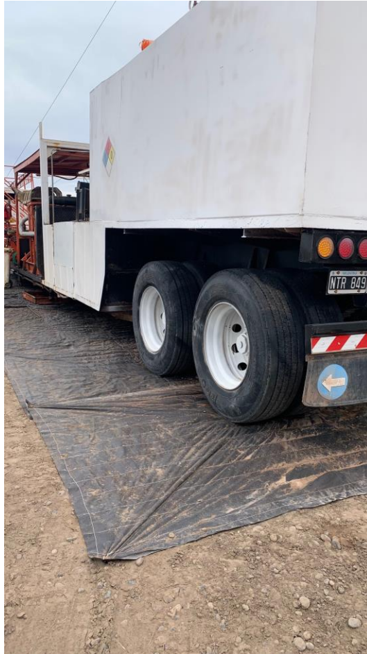
Figura N° 35. Equipo de Pulling. Mantas bajo almacenamiento de combustible
