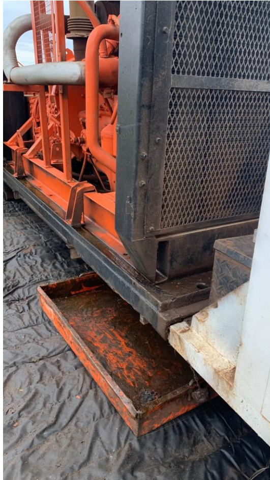
Figura N° 34. Equipo de Pulling. Combinación de mantas y bandejas
