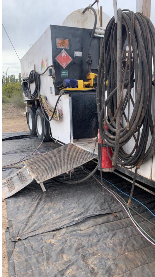
Figura N° 37. Equipo de Pulling. Mantas debajo de equipos de circulación de fluidos
