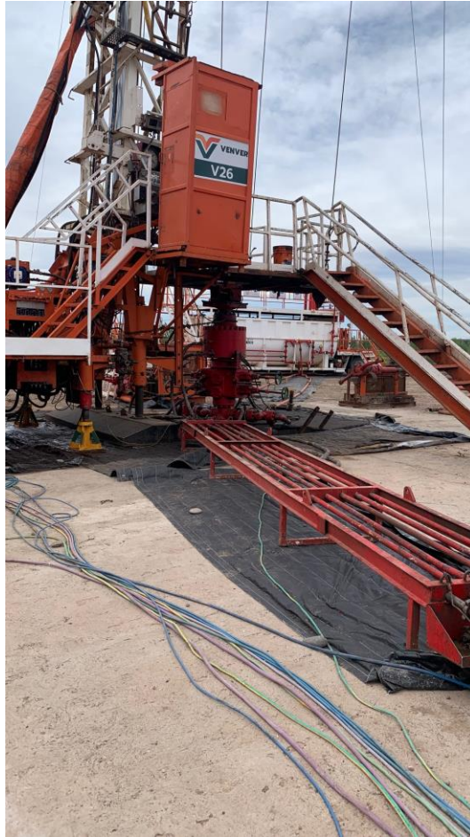
Figura N° 39. Equipo de Pulling. Mantas debajo de varillas
