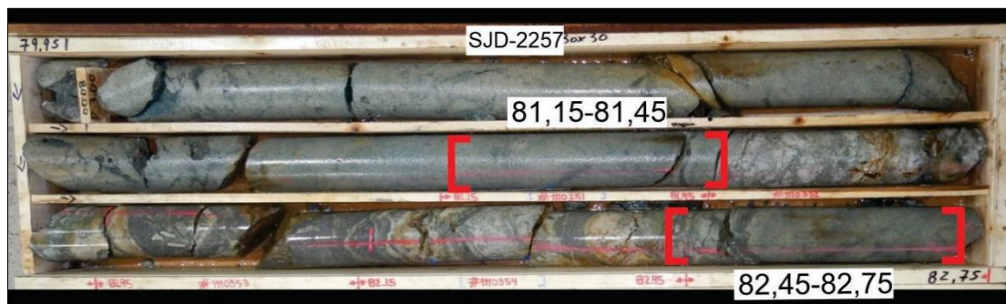
Figura 4.4. Fotografía general del sondeo SJD-2257. El tramo 81,15-81,45 m corresponde a la roca de caja de techo y el tramo 82,45-82,75 m a la roca de caja de piso. La veta Micaela fue interceptada entre 81,45 y 82,45 m.
