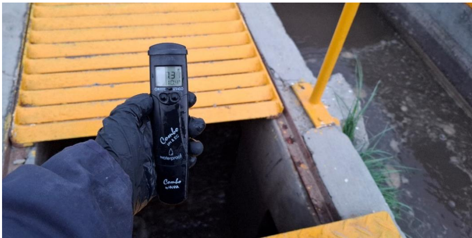
Fig 10: Determinación de parámetros físico-químicos utilizando el equipo multiparamétrico. Fuente: Elaboración propia.
