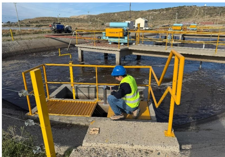
Fig 9: Muestreo del licor mezcla en reactor aeróbico. Fuente: Elaboración propia.
