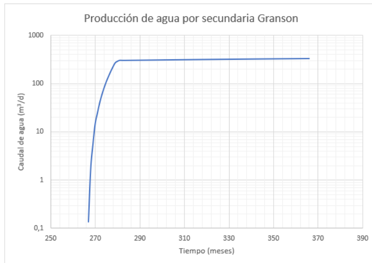
Figura 4.8.5.4 – Incremento de producción de agua debido a la recuperación secundaria
