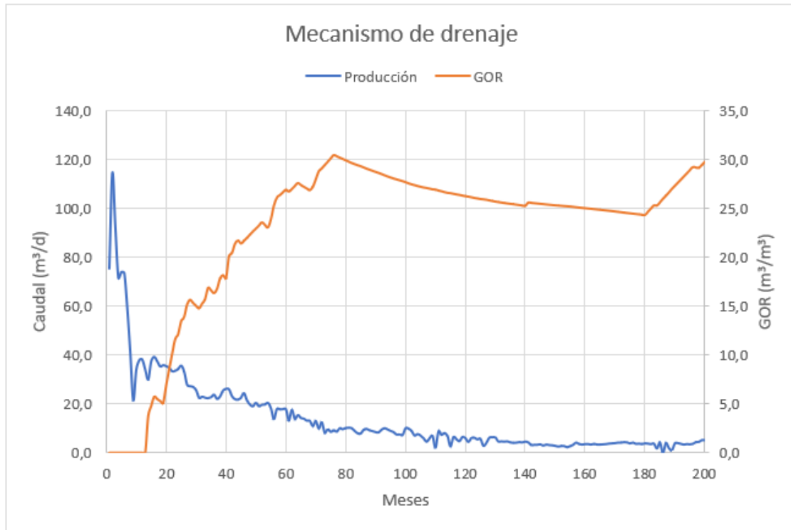
Figura 3.8.2 – Curvas de producción y GOR del pozo Gr.a-603
