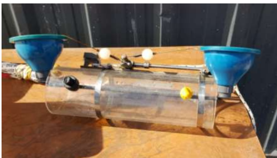
Figura 3: Botella Van Dorn utilizada para la toma de muestras de agua de mar.
