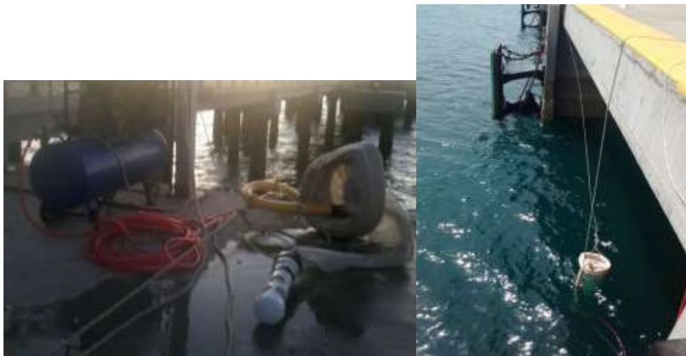
Figura 5: A la izquierda se puede ver el mecanismo de bombeo fuera del agua, compresor, manguera de aire (roja), manguera de bombeo (amarilla) y red con vaso colector para el material biológico. A la derecha se puede ver el mecanismo funcionando durante un bombeo.
