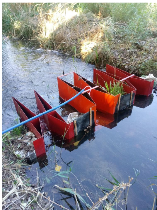
Figura 16: Aforador sin cuello con sensor de presión que permite obtener el tirante en garganta.
