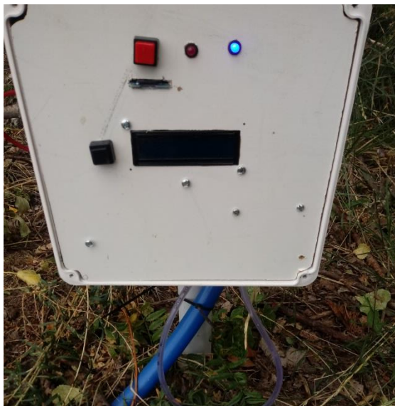
Figura 17: Sistema de monitoreo, que registra y almacena en forma continua para un determinado paso de tiempo los tirantes, en una tarjeta de memoria.
