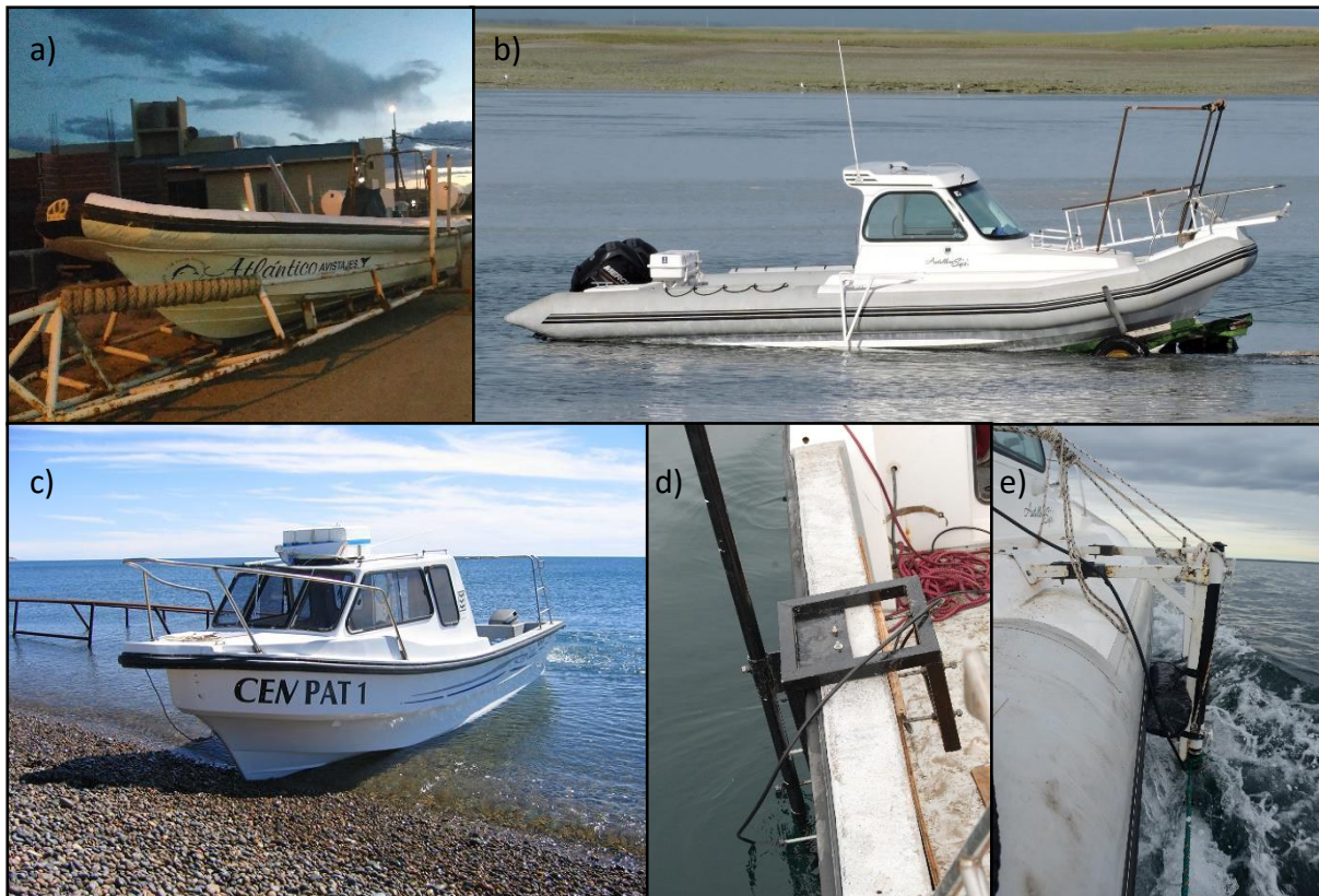
Figura 1.4. Plataformas utilizadas para las prospecciones acústicas. El a) Atlántico y el b) Kamal se utilizaron en el golfo San Matías, mientras que la c) Cenpat 1 se utilizó en el golfo Nuevo. En d) y e) se muestra un detalle de los soportes de la ecosonda en la Cenpat 1 el Kamal y respectivamente.
